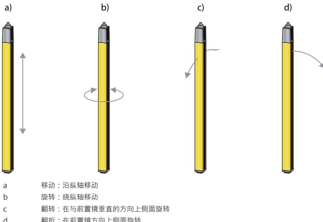
图 6.6: 校准安全传感器的移动方向
