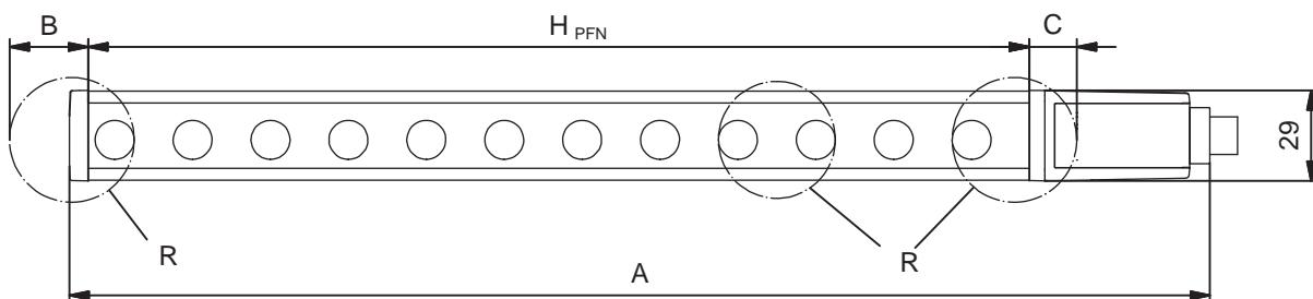
图 14.1: 发射器和接收器尺寸
