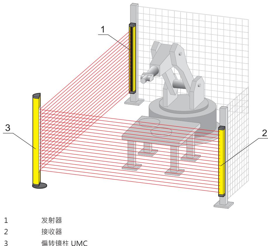
图 6.12: 通过偏转镜柱实现双面防护
