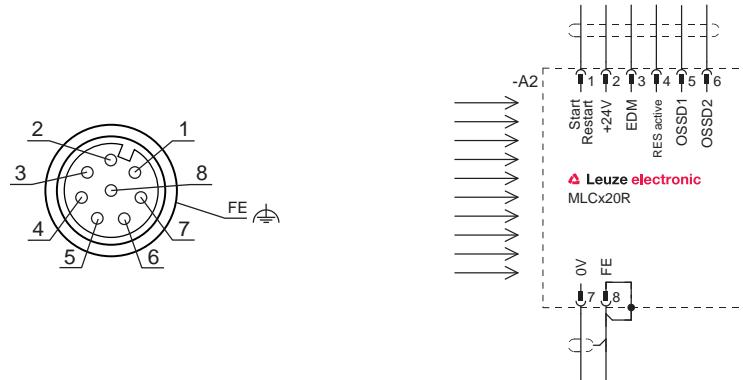
图 7.3: 接收器的插头分配和接线图
