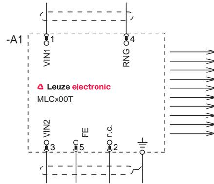
그림 7.1: 송신기 플러그 배열 및 연결도
