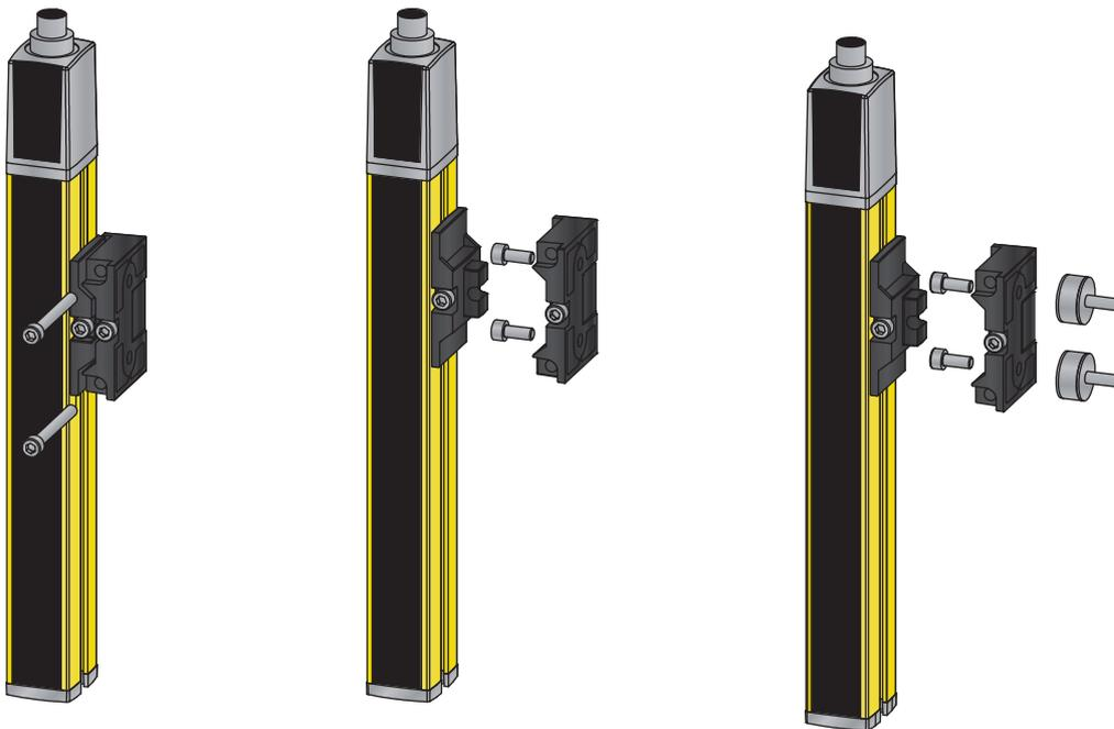
Fig. 6.9: Montage à l'aide de supports pivotants BT-2SB10
