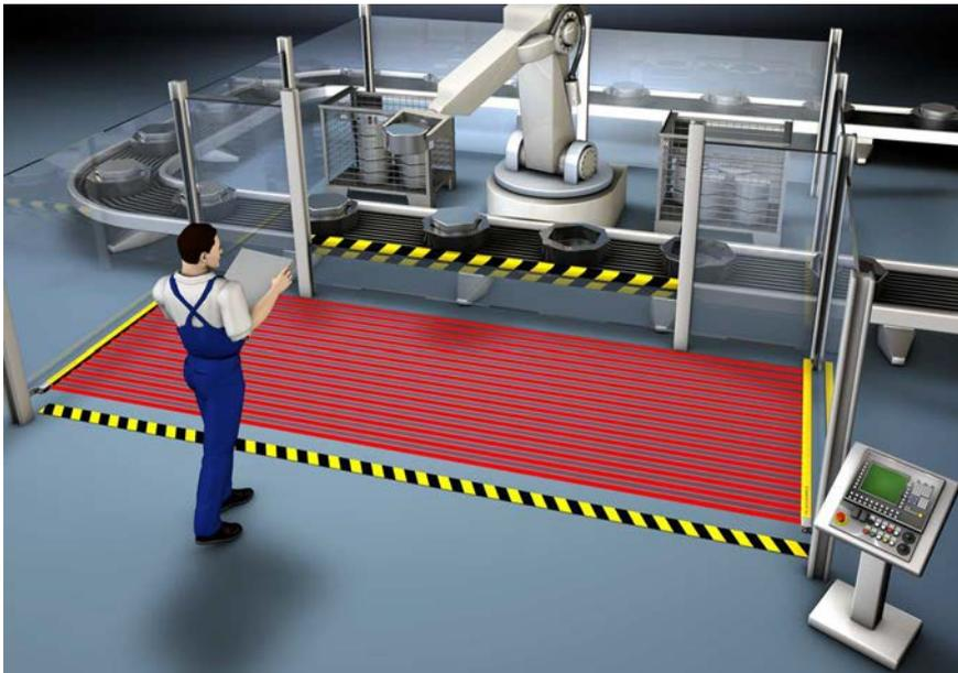
그림 5.4: 로봇에서의 위험 지역 안전 조치
