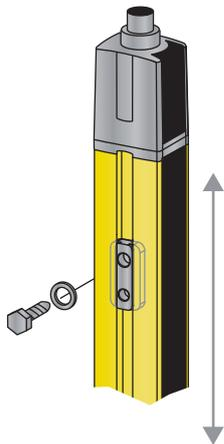
그림 6.7: 슬롯 너트 BT-NC60을 이용한 설치
