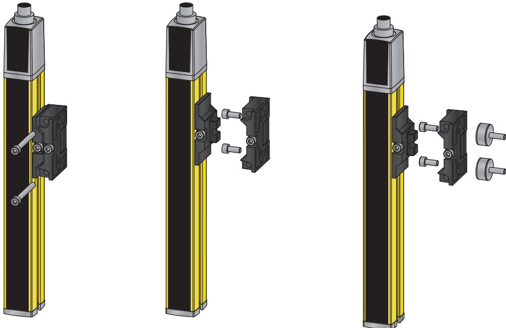
그림 6.9: 회전식 브래킷 BT-2SB10을 이용하여 설치
