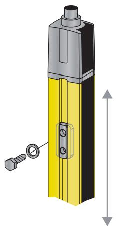
그림 6.7: 슬롯 너트 BT-NC60을 이용한 설치
