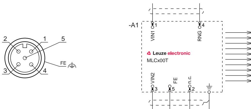
그림 7.1: 송신기 플러그 배열 및 연결도
