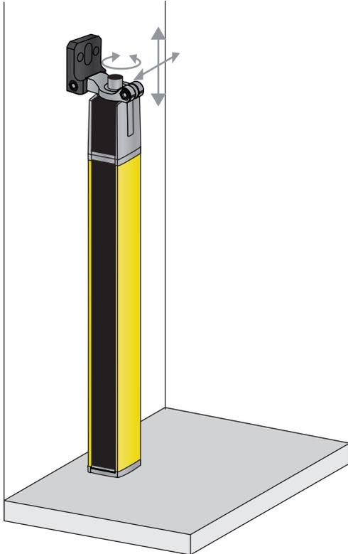
Fig. 6.10: Fixação diretamente à bancada da máquina
