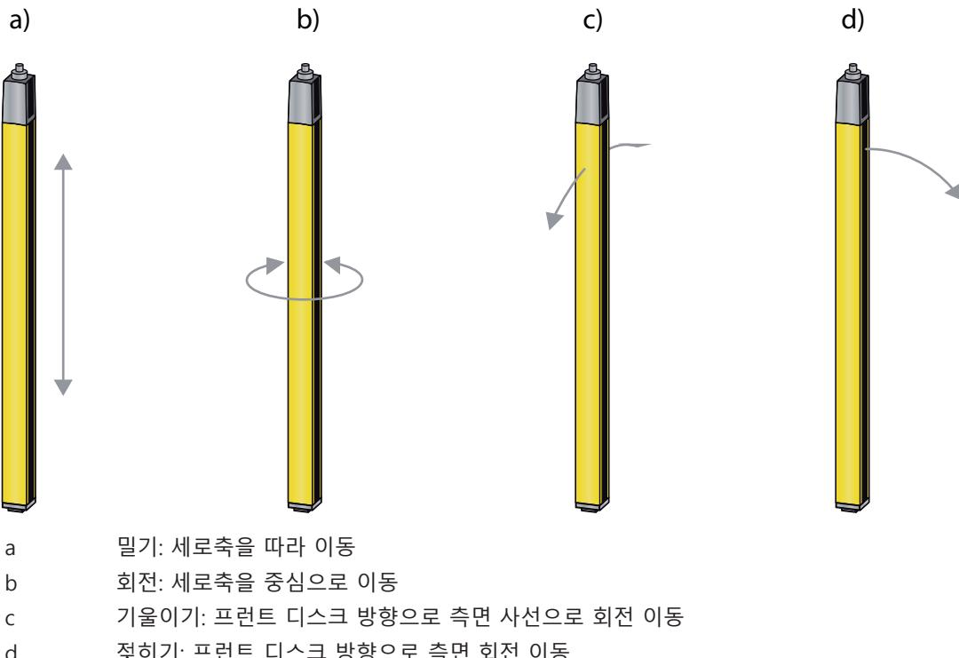
그림 6.6: 안전 센서 정렬 시 움직임 방향
