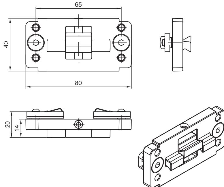
그림 14.5: UDC 장치 칼럼에 고정하기 위한 클램프 고정장치 BT-P40
