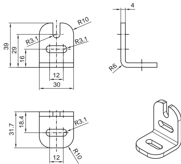
그림 14.2: 각도 고정 장치 BT-L
