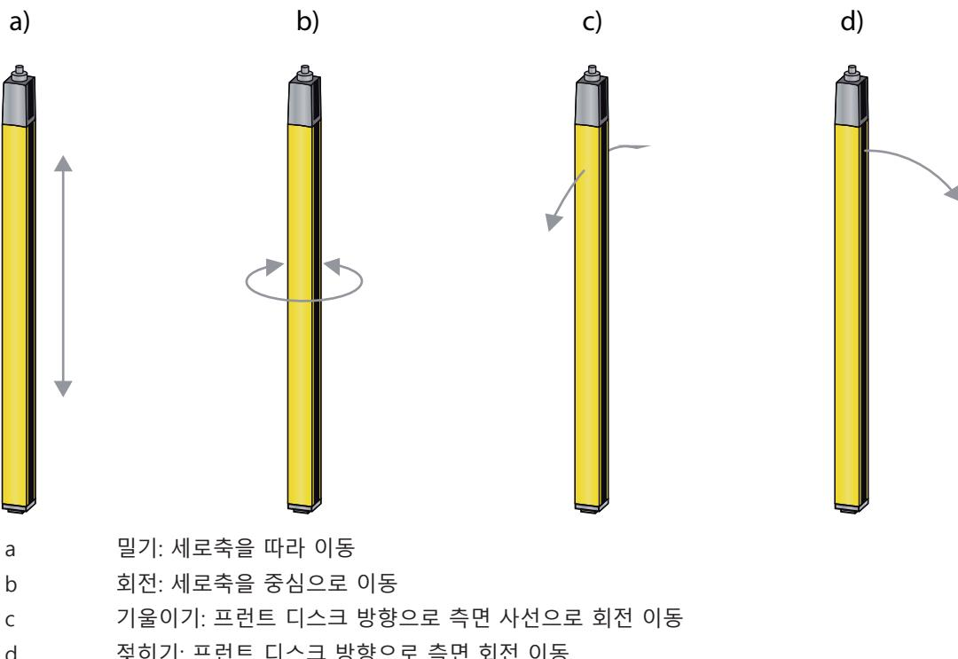
그림 7.6: 안전 센서 정렬 시 움직임 방향
