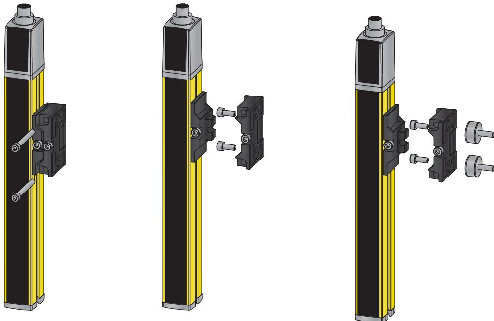
그림 7.9: 회전식 브래킷 BT-2SB10을 이용하여 설치
