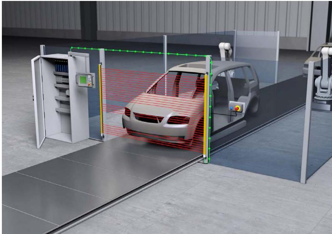
그림 6.1: 자동차 생산 라인에서 스마트 프로세스 게이팅(SPG)
