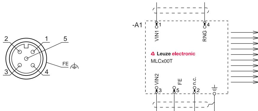
그림 8.1: 송신기 플러그 배열 및 연결도
