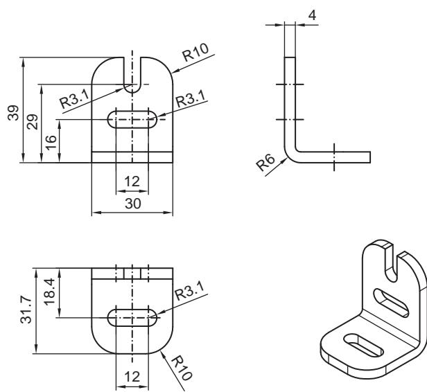
그림 15.3: 각도 고정 장치 BT-L
