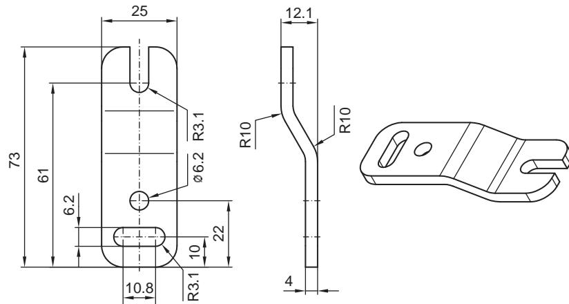
그림 15.4: 병렬 고정 장치 BT-Z
