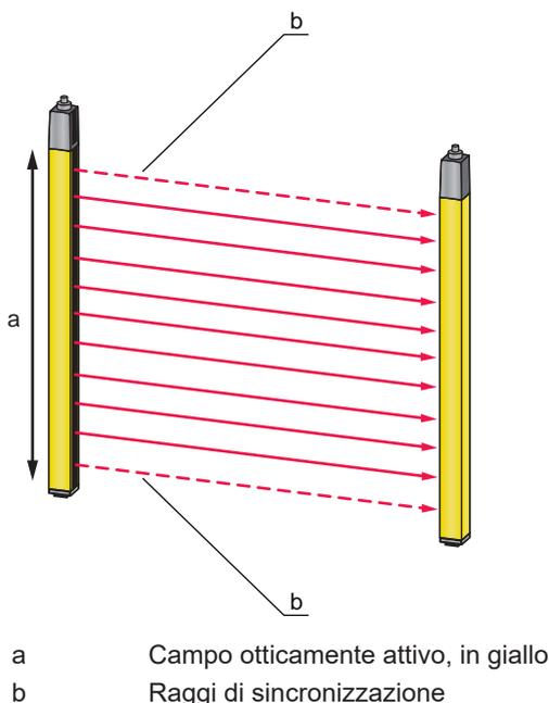
Figura 3.1: Sistema trasmettitore-ricevitore
