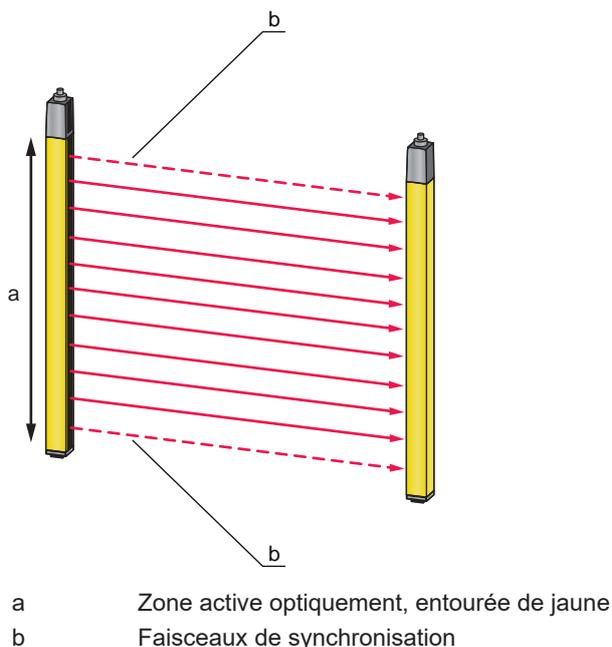
Fig. 3.1: Système émetteur-récepteur
