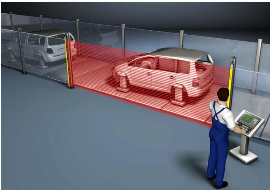
Fig. 5.3: Sécurisation d'accès à une voie transfert
