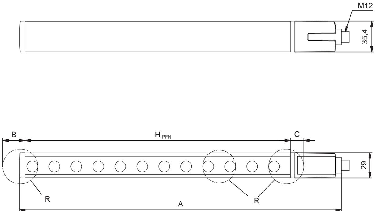
Fig. 14.1: Dimensions de l'émetteur et du récepteur
