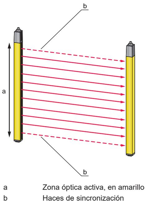
Figura 3.1: Sistema emisor-receptor
