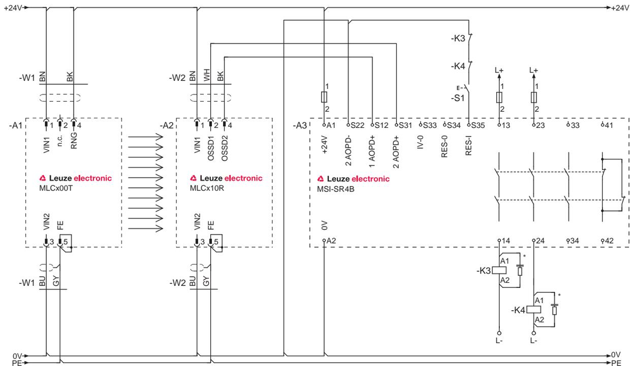
Bild 7.4: Schaltungsbeispiel mit nachgeschaltetem Sicherheits-Schaltgerät MSI-SR4B
