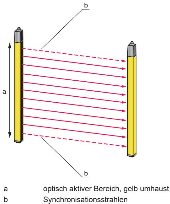
Bild 3.1:      Sender-Empfänger-System
