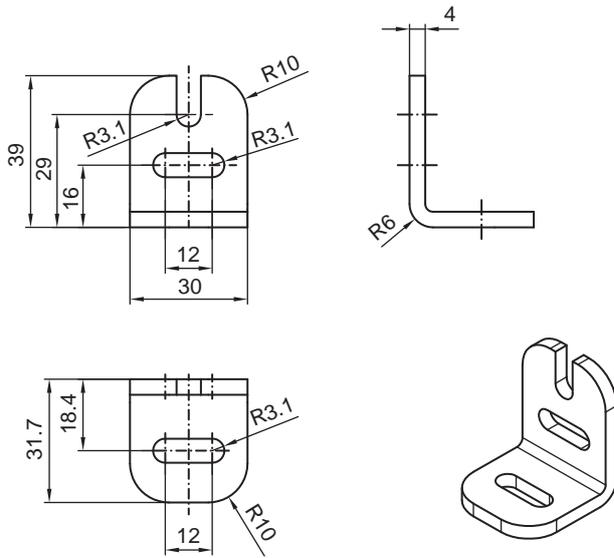
Bild 14.2: Winkelhalterung BT-L
