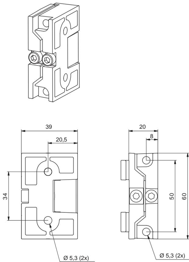
Bild 14.6: Schwenkhalterung BT-2SB10
