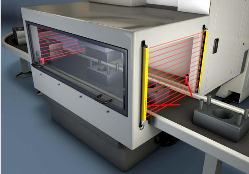
그림 5.4: 류팅을 이용한 위험 지점 안전 장치
