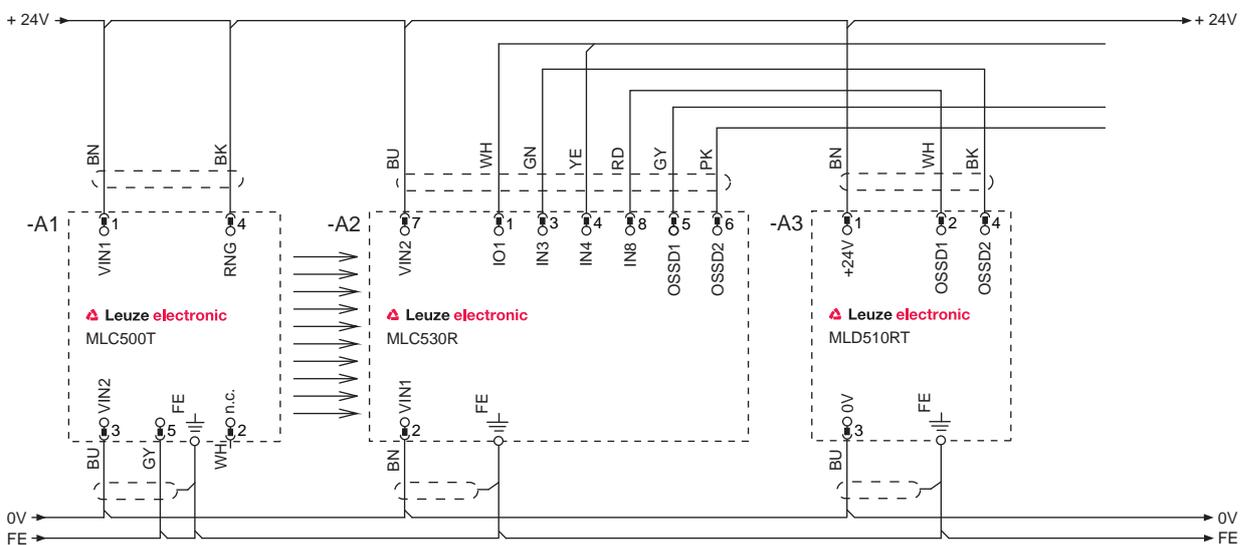
그림 7.7: 작동 모드 2: 입구와 구역의 결합 모니터링을 위한 전기 안전 스위치 출력부 회로 예
