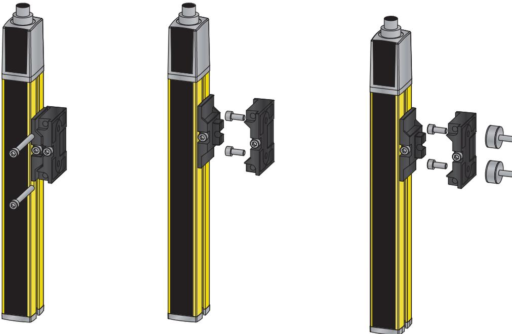
그림 6.13: 회전식 브래킷 BT-2SB10을 이용하여 설치
