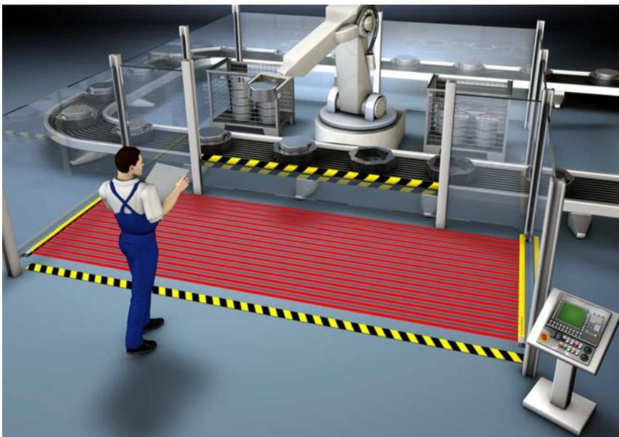
그림 5.5: 로봇에서의 위험 지역 안전 조치
