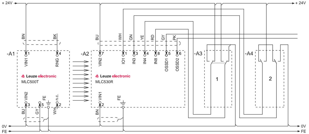
그림 7.9: 작동 모드 3: 블랭킹된 대상물 모니터링을 위한 인터링크된 접촉 기반 위치 스위치와 기능 그룹 FG1과 FG2 사이를 전환하기 위한 전환 스위치 회로 예
