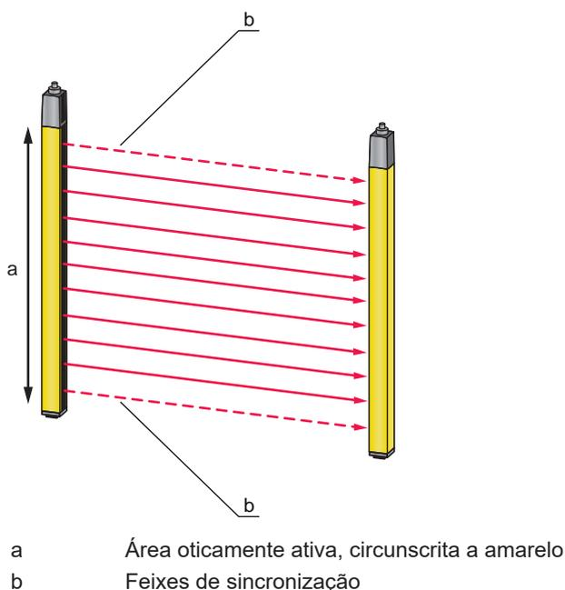
Fig. 3.1: Sistema transmissor/receptor
