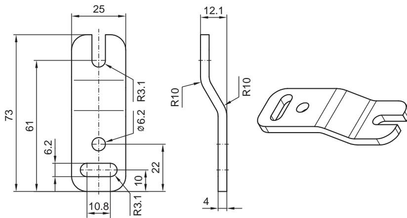
그림 14.3: 병렬 고정 장치 BT-Z
