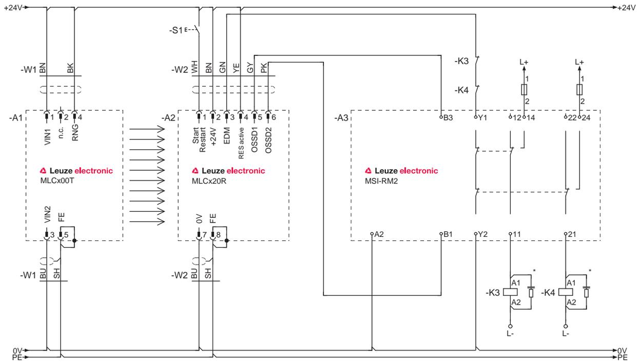
图 7.4: 带后置安全控制器MSI-RM2的接线示例
