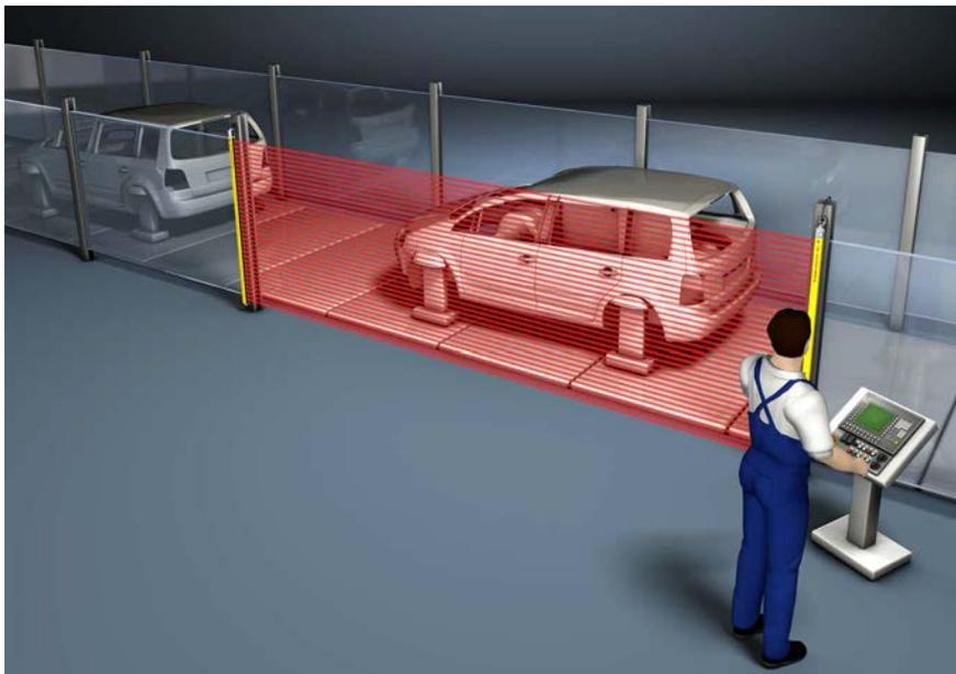
图 5.3: 传输线上的门禁防护
