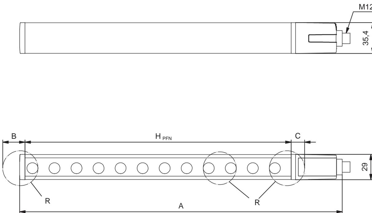
图 14.1: 发射器和接收器尺寸
