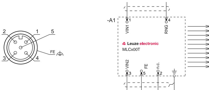
图 7.1: 发射器的插头分配和接线图
