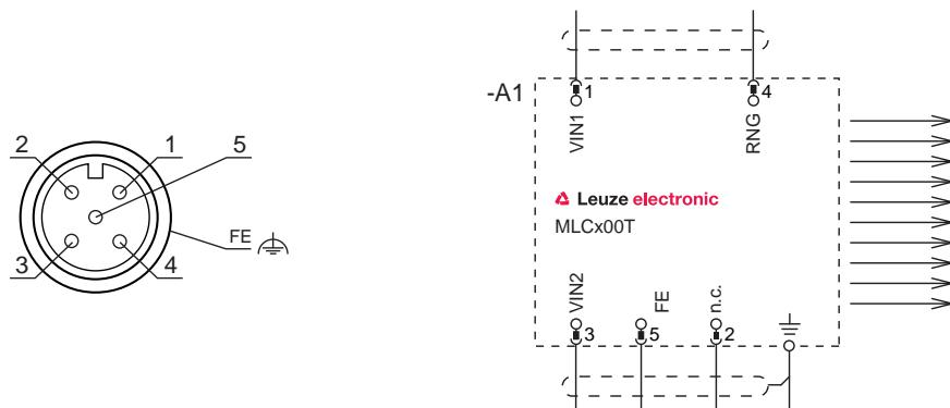
그림 7.2: 송신기 플러그 배열 및 연결도
