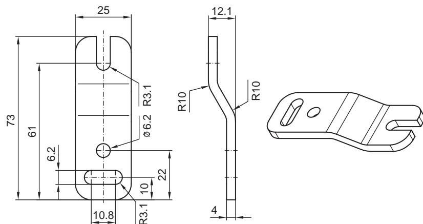
그림 14.3: 복렬 고정 장치 BT-Z
