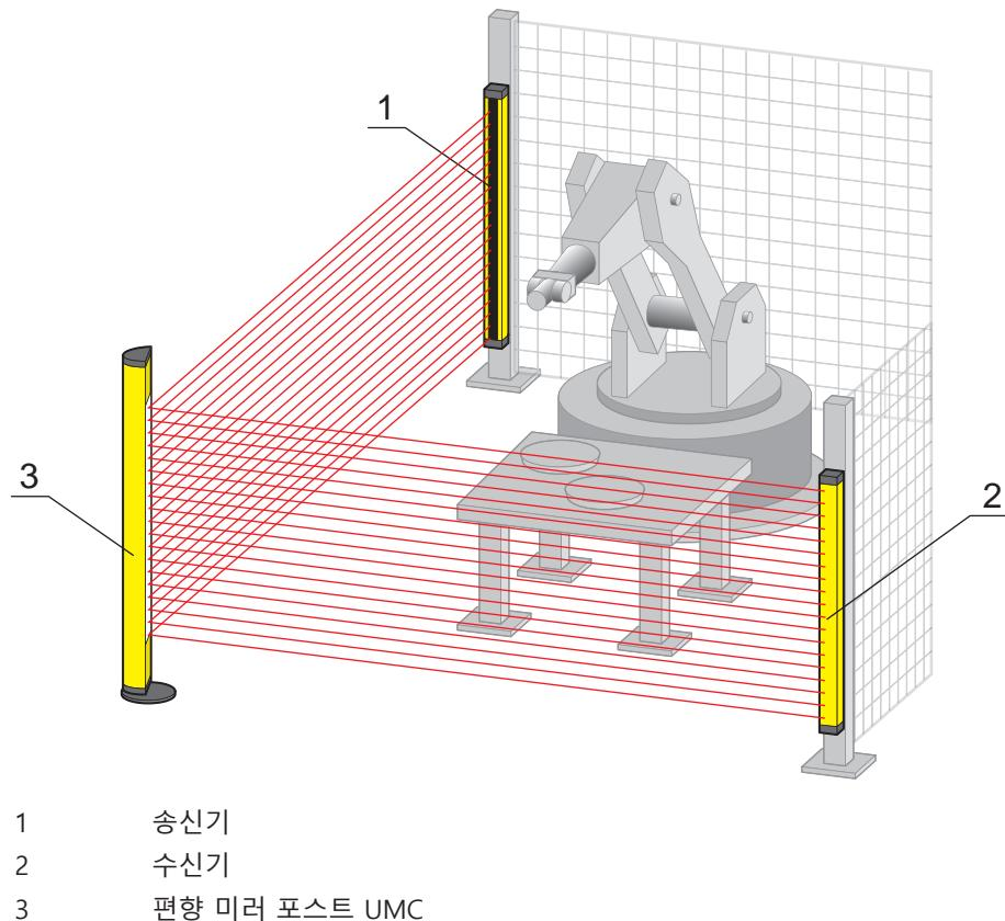
그림 6.12: 위험 지점의 2면 안전 조치를 위한 편향 미러 배열
