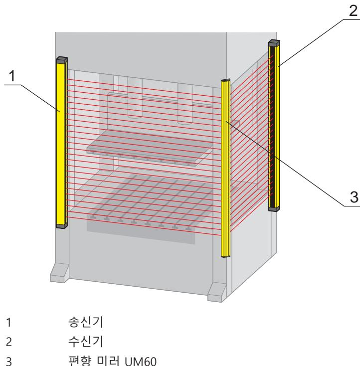
그림 6.11: 위험 지점의 2면 안전 조치를 위한 편향 미러 배열
