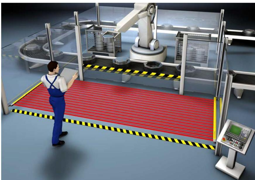
Figura 5.4: Protezione di aree pericolose presso un robot
