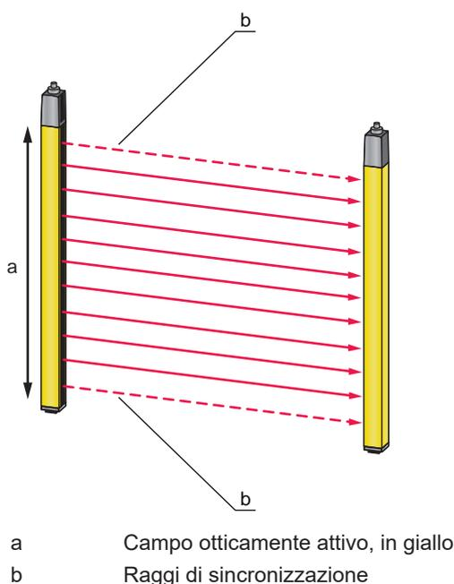
Figura 3.1: Sistema trasmettitore-ricevitore
