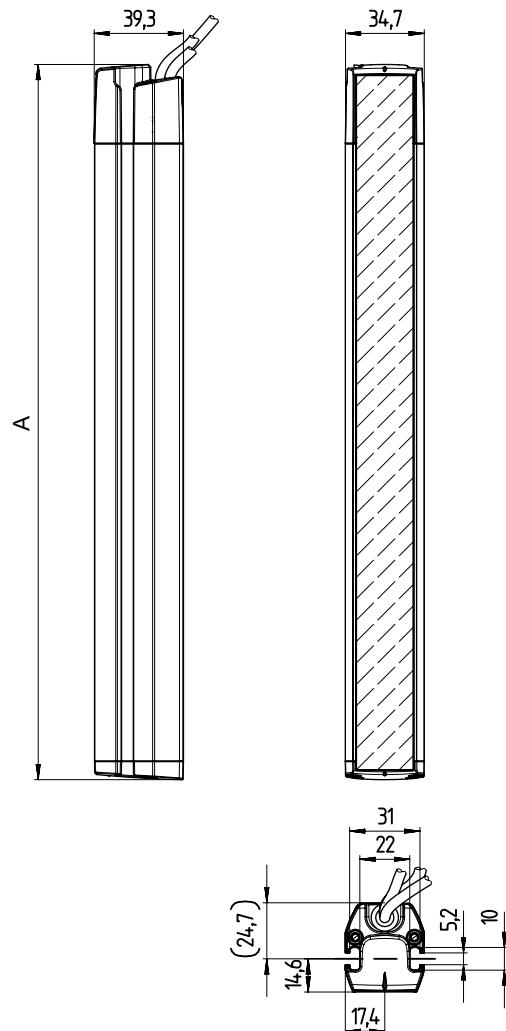
图 12.1: 发射器和接收器尺寸
