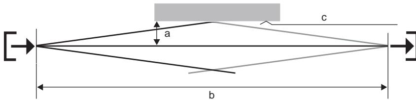
a 所要求的与反射平面的最小距离 [mm]
