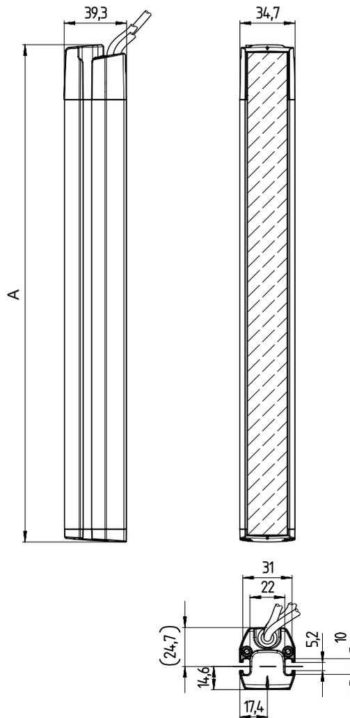
Fig. 12.1: Dimensions de l'émetteur et du récepteur
