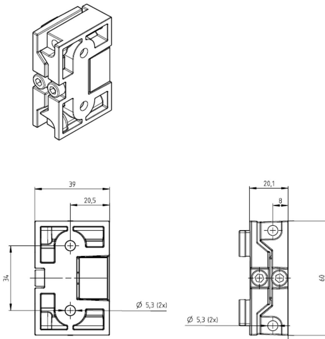
Fig. 12.2: Support pivotant pour montage en rainure BT-SB05
