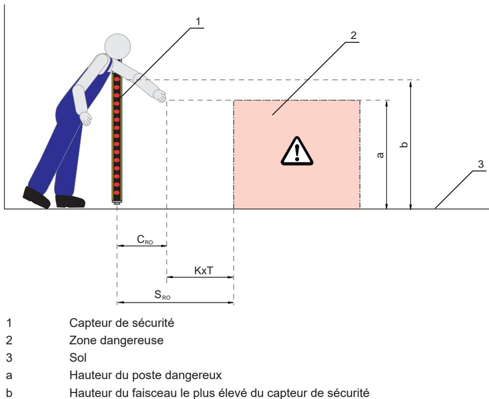
Fig. 5.1:      Supplément à la distance de sécurité en cas de contournement par le haut
