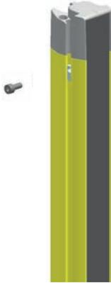
Fig. 5.6: Montage à l'aide d'écrous coulissants
