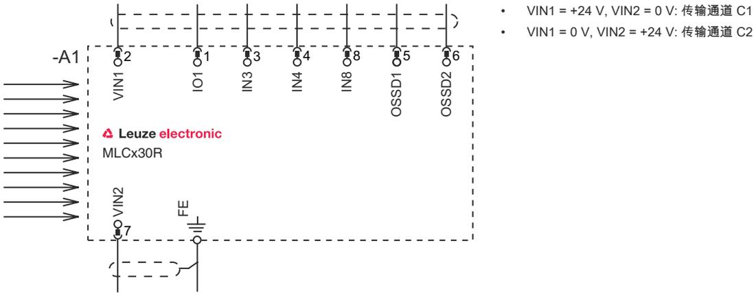
运行模式1：联接了限位开关的接线示例，用于监控固定消隐的机器部件
