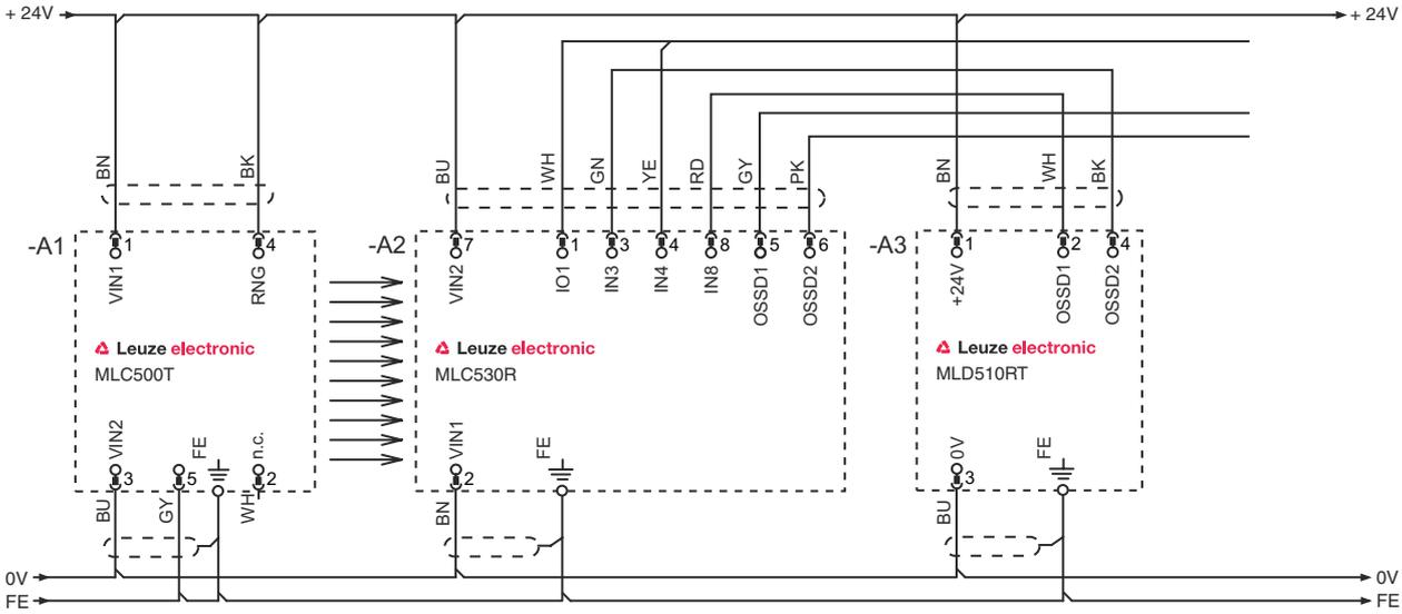
运行模式3：带触点式限位开关（用于监控消隐物体）和转换开关（用于切换功能组FG1和FG2）的接线示例
