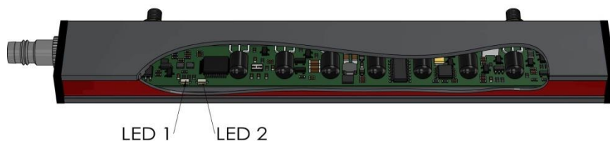
Figure 6: Témoins lumineux/diagnostic d'erreur
