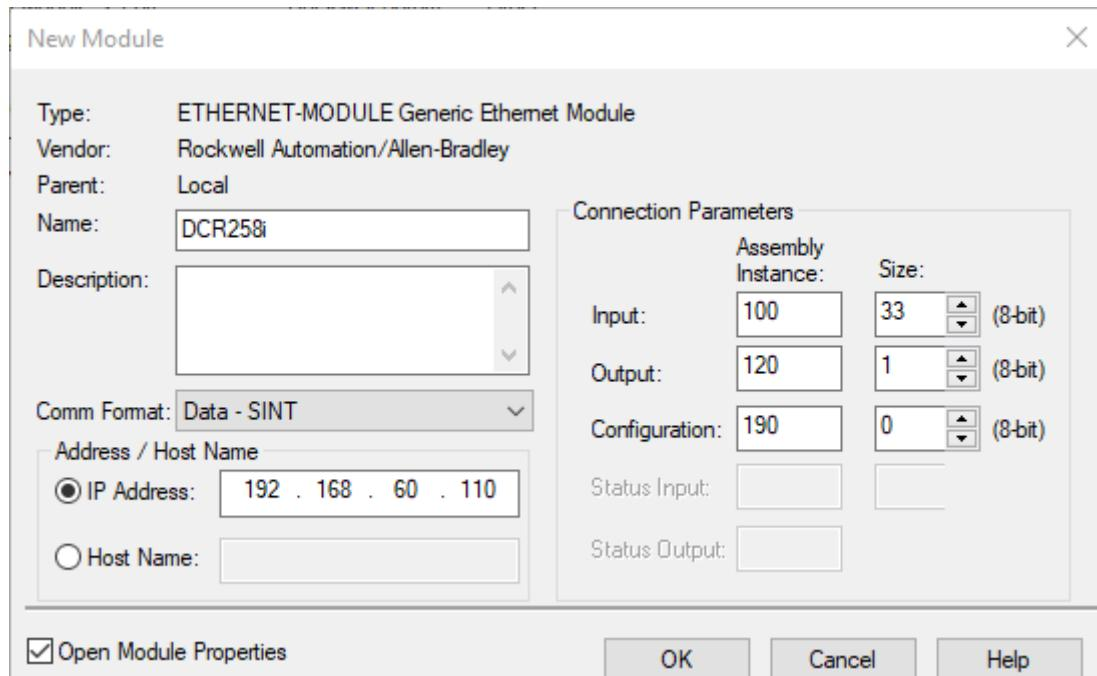
그림 10.5: 설정 예시 – Generic Module을 이용한 모듈 정의
