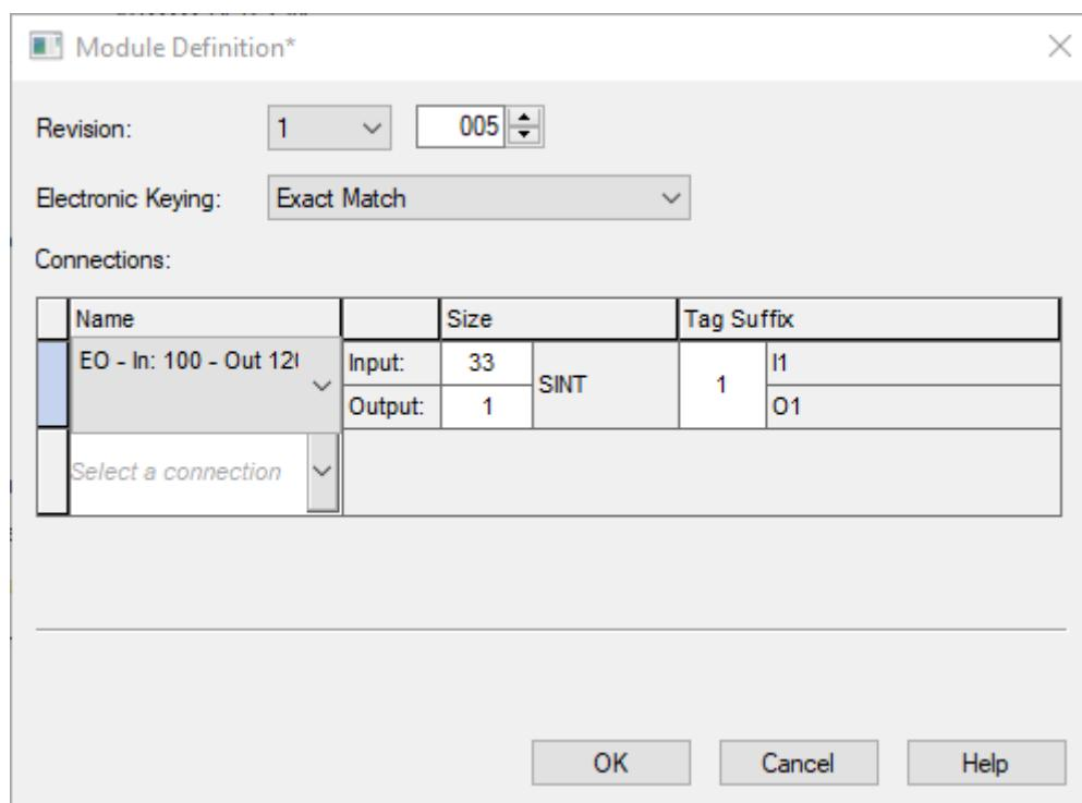
그림 10.6: 설정 예시 – EDS 파일을 이용한 모듈 정의
