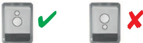
Fig. 6.23: Orientation du film diffuseur
