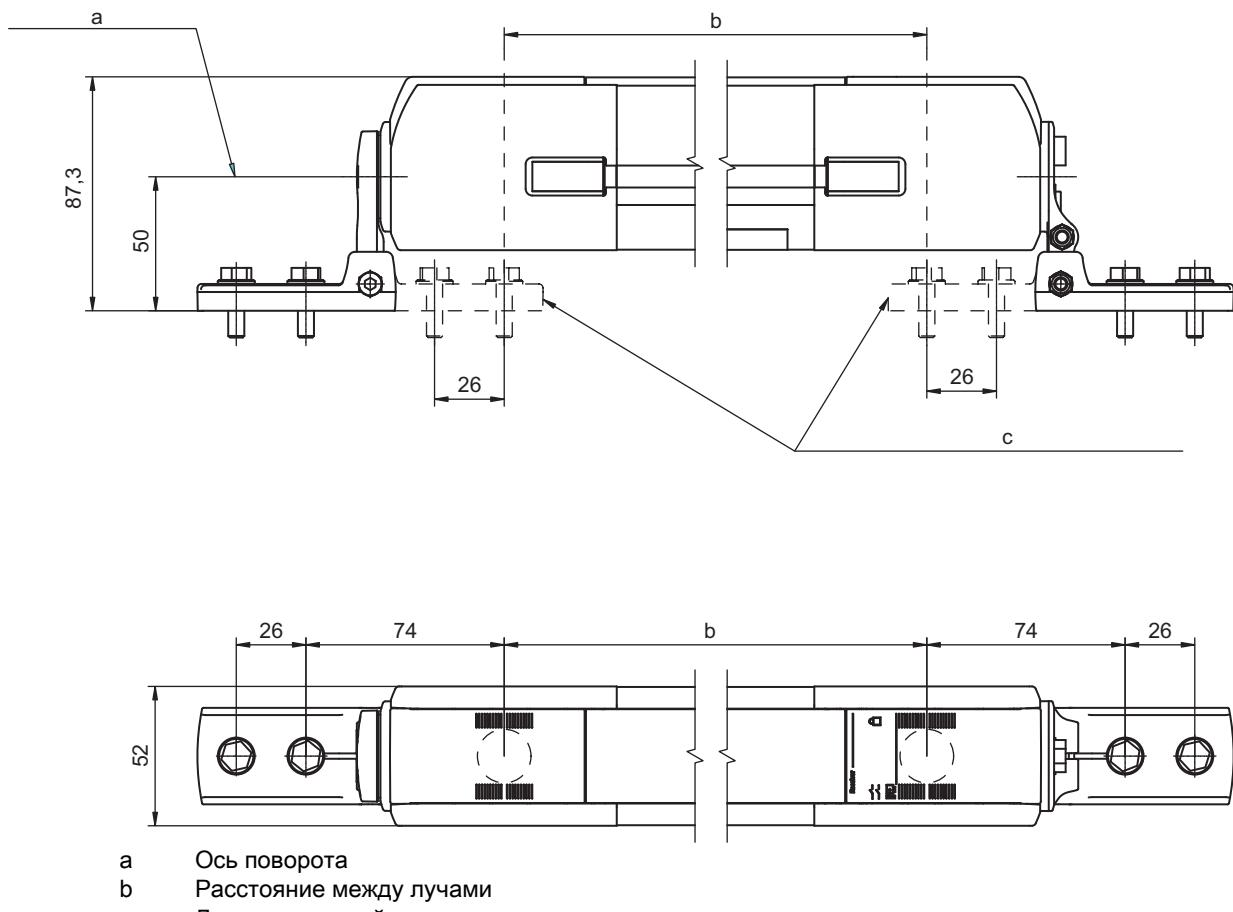
Рис. 14.11: Установочные размеры BT-240B, BT-240C
