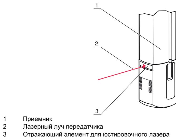
Рис. 8.3: Применение встроенного юстировочного лазера: лазерный луч передатчика падает на отражающий элемент на приемнике, отражающий элемент ярко освещен
