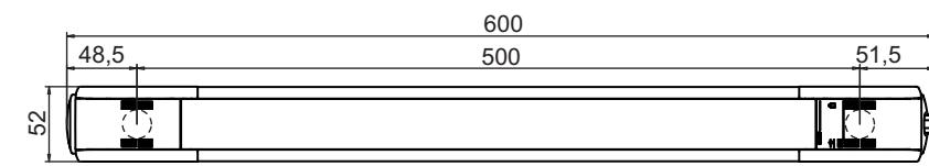
Рис. 14.5: Размеры MLD, 2-лучевой приемопередатчик
