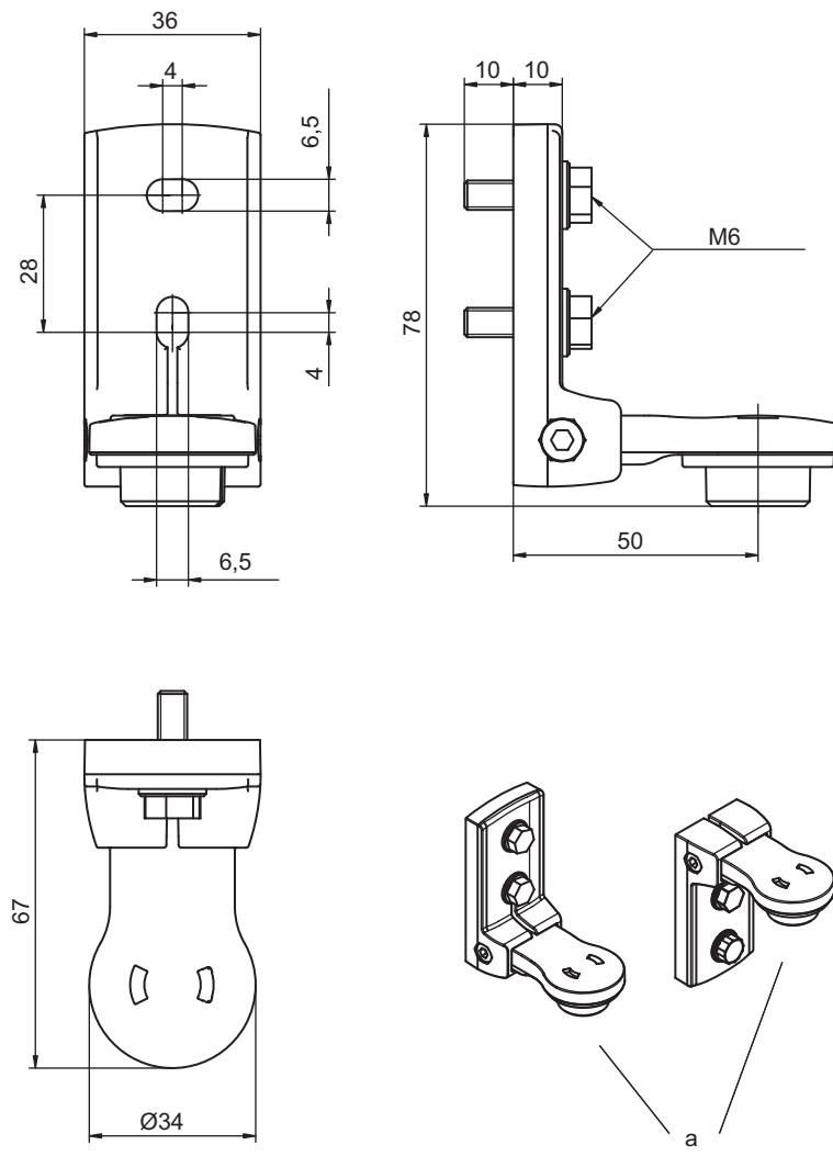
Рис. 14.9: Поворотный держатель BT-240B
