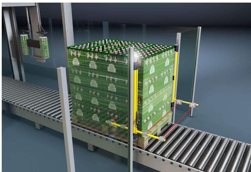
Рис. 5.4: Защита доступа в рабочую зону роликового конвейера с применением подавления с 4 датчиками с управлением по времени (MLD 535 с предварительно установленными комплектами датчиков подавления)
