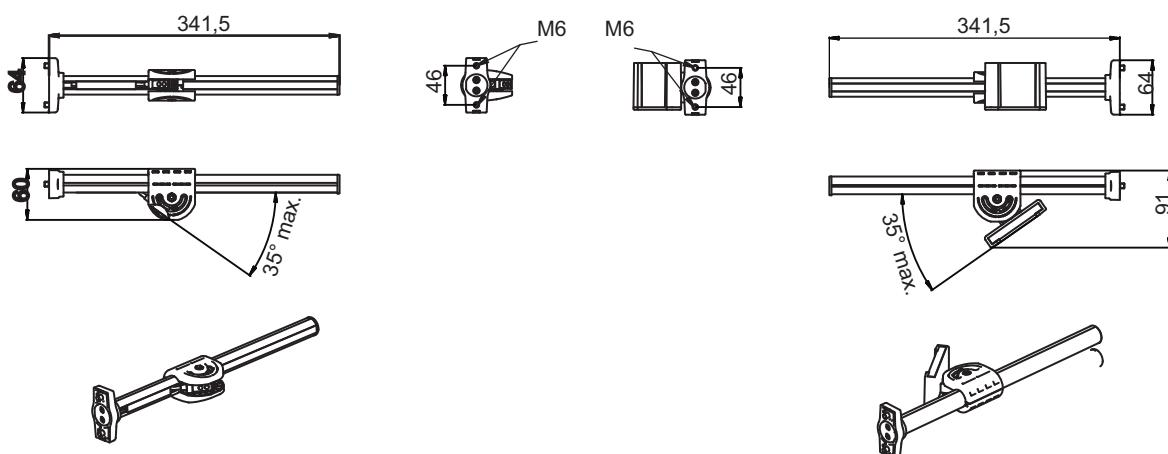
Рис. 14.14: Комплект датчиков подавления, последовательное подавление с 2 датчиками
