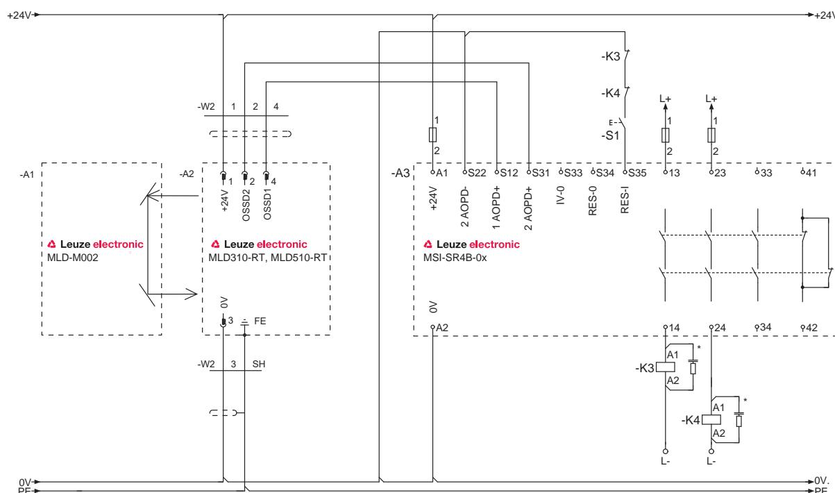
Рис. 7.8: Пример подключения MLD 510 (система приемопередачи) с EDM; RES в защитном переключающем устройстве MSI-SR4B-0x
