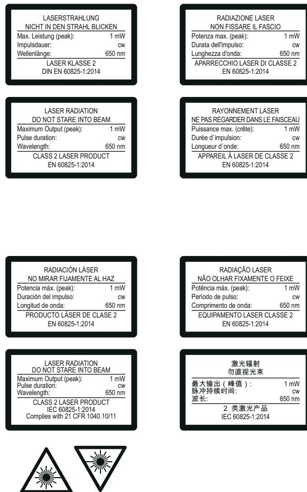
Рис. 2.2: Предупредительные и указательные таблички об использовании лазера — прилагаемые наклейки
