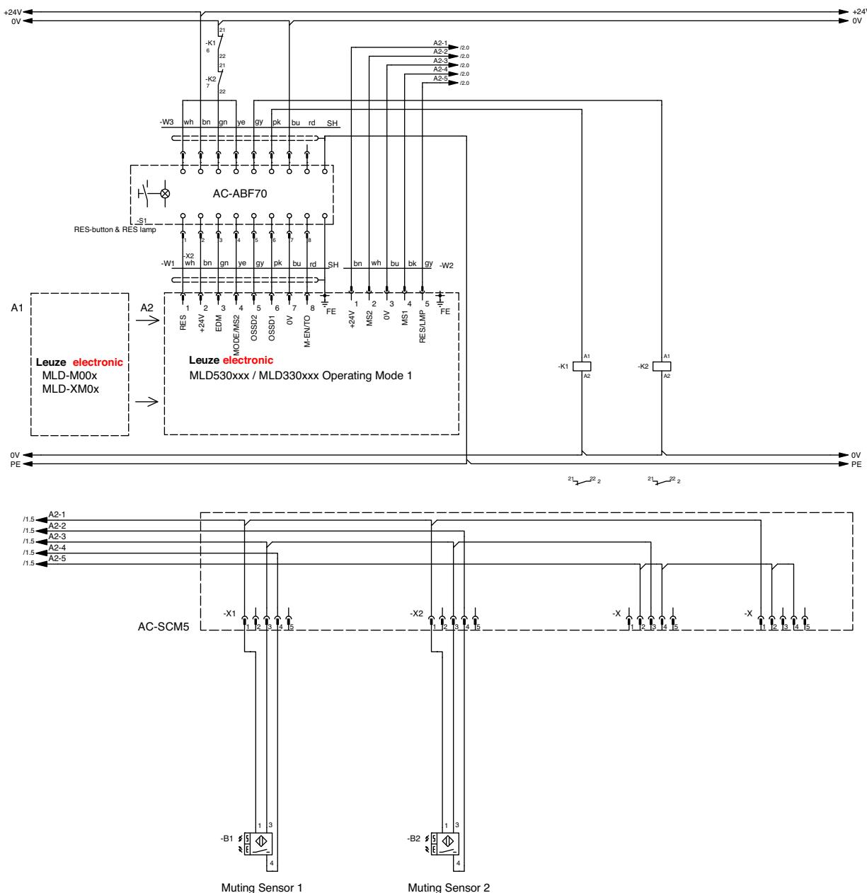
Рис. 7.10: Пример подключения системы приемопередатчика MLD 330, MLD 530: подавление с 2 датчиками с управлением по времени с выдержкой времени подавления 10 минут (приемопередатчик подключается аналогично)
