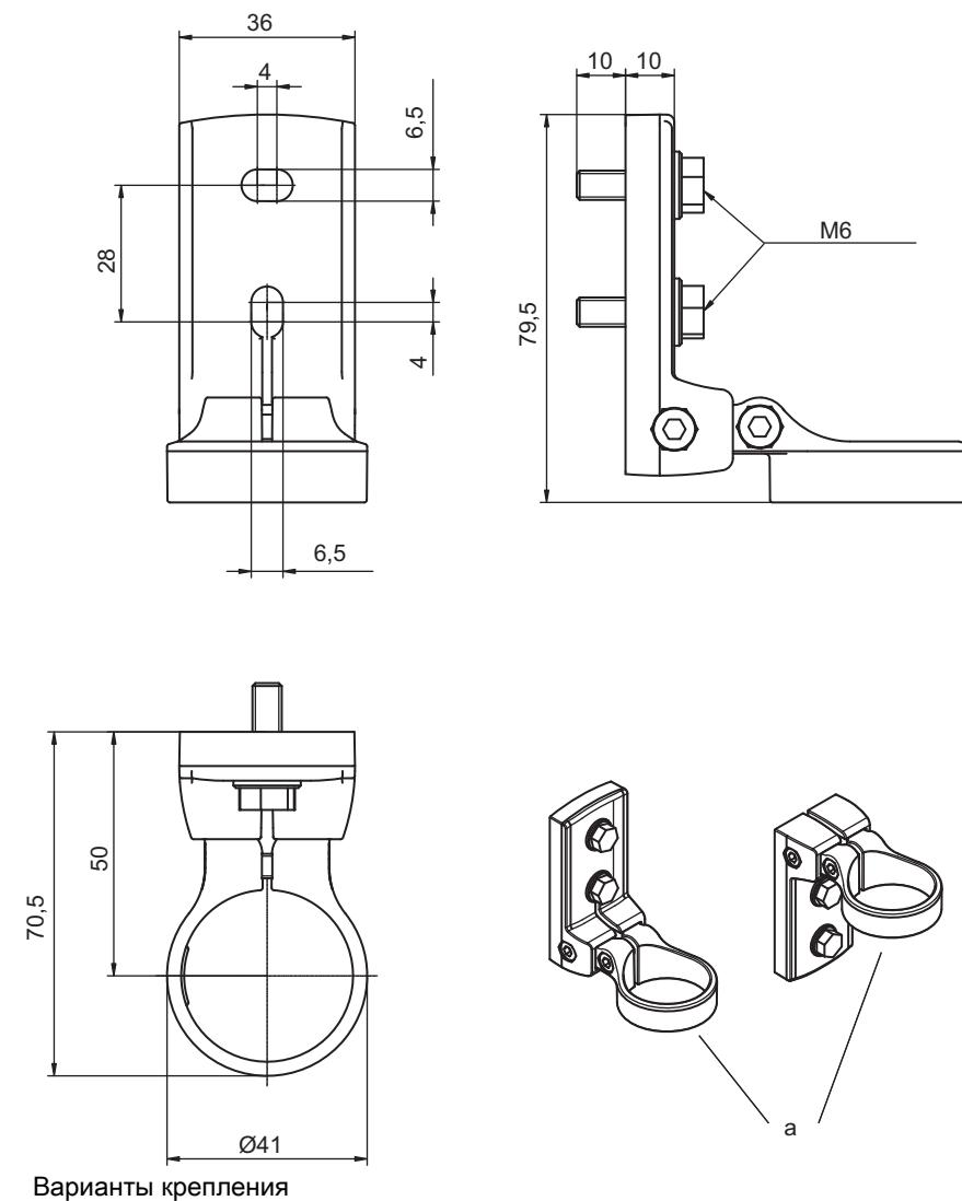
Рис. 14.10: Поворотный держатель BT-240C
