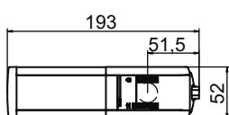
Рис. 14.1: Размеры MLD, 1-лучевой передатчик, приемник
