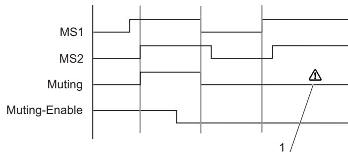
Рис. 4.11: Пример: сбой сигнала разрешения на включение подавления
