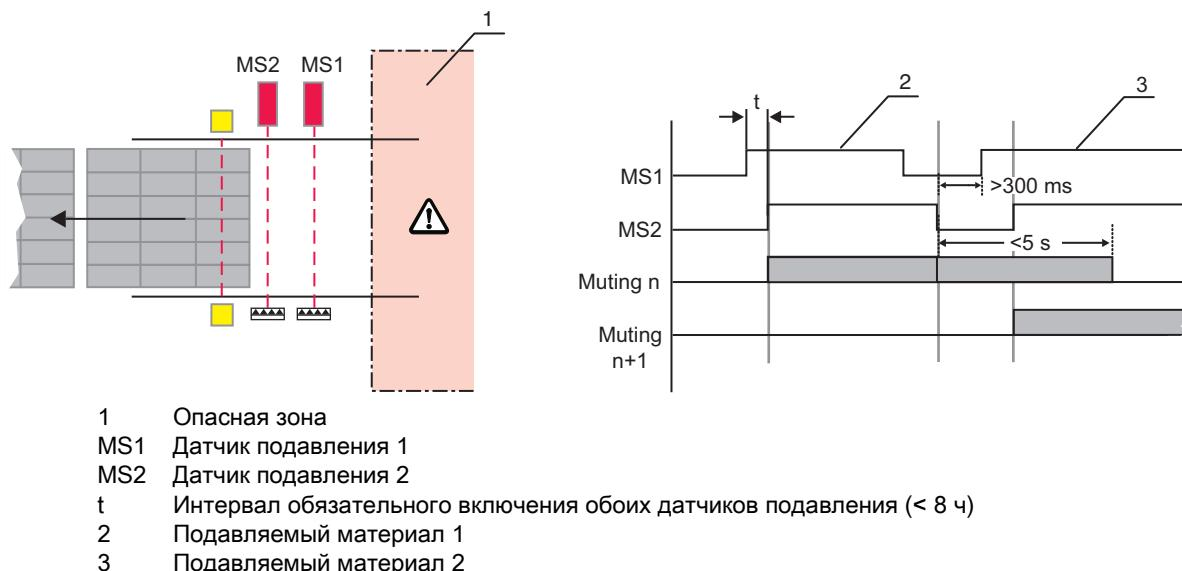
Рис. 4.4: Подавление при непрерывной подаче объектов – расположение датчиков подавления и временная диаграмма
