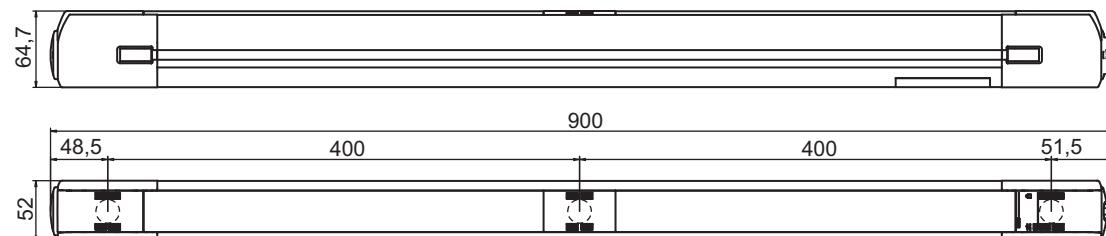
Рис. 14.3: Размеры MLD, 3-лучевой передатчик, приемник
