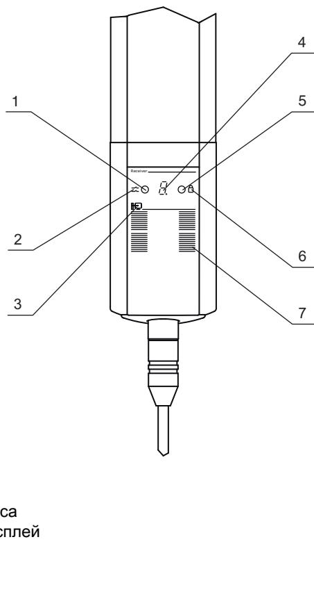
Рис. 3.5: 7-сегментный дисплей на приемнике MLD 320, MLD 330, MLD 335, MLD 520, MLD 530, MLD 535
