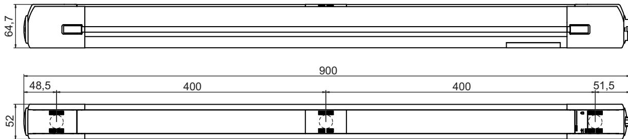
Рис. 14.6: Размеры MLD, 3-лучевой приемопередатчик
