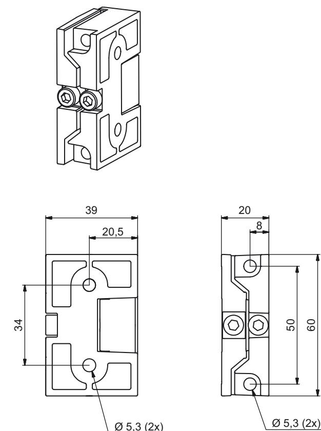
Рис. 14.13: Зажимной поворотный держатель BT-2SB10
