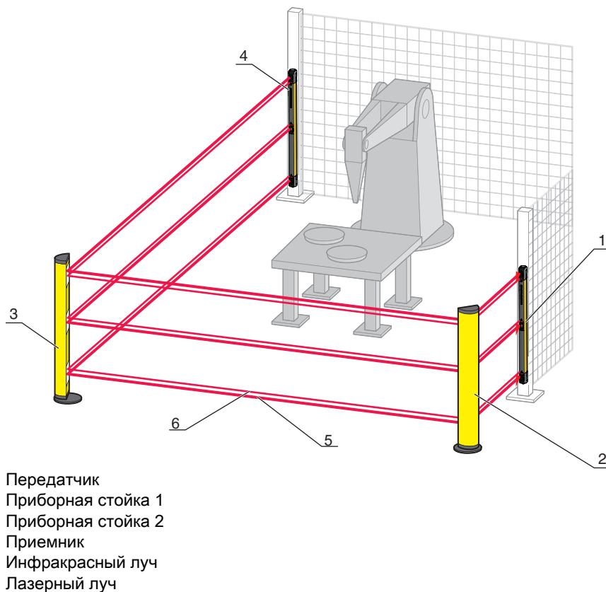
Рис. 8.1: Реализация многосторонней защиты доступа с помощью встроенного юстировочного лазера. Передатчик по возможности устанавливается в точке наименьшего расстояния до стойки с отклоняющими зеркалами.
