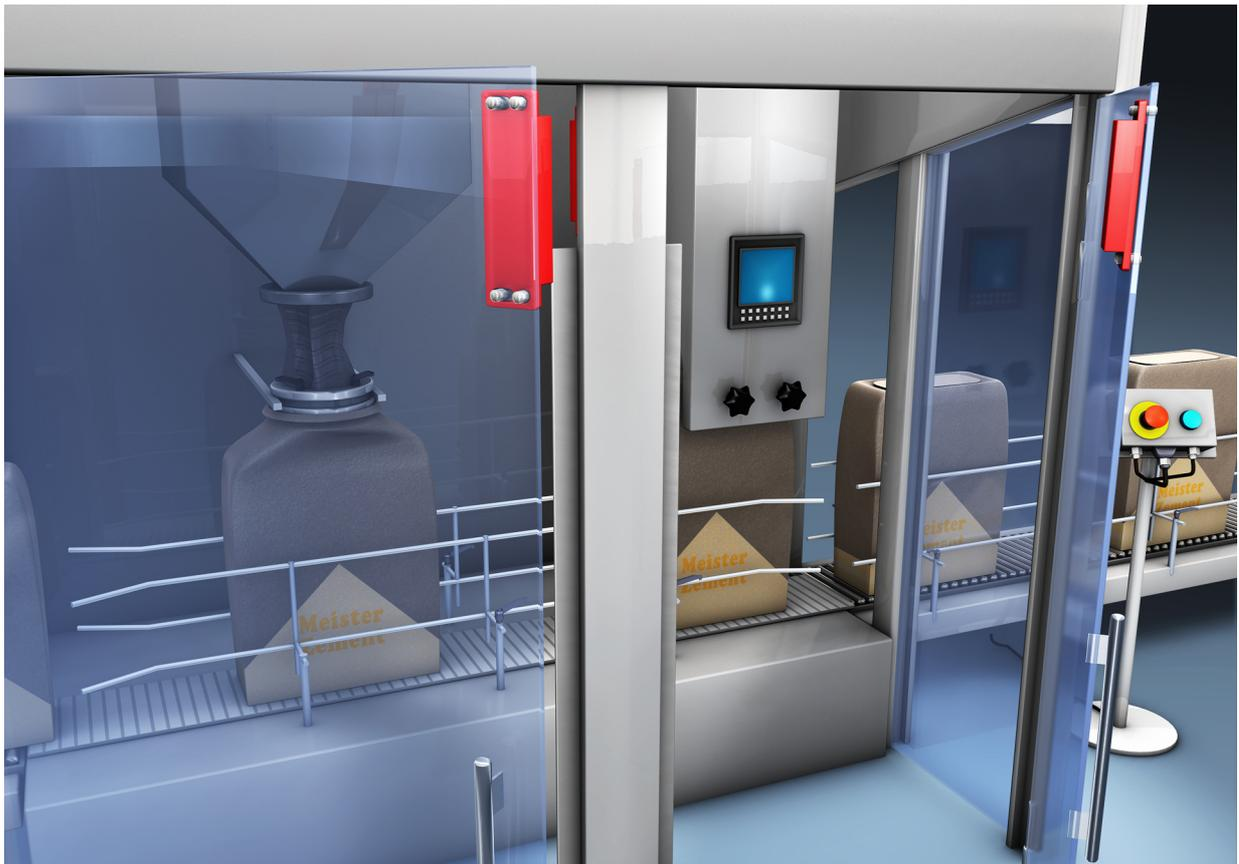
Figure 5.2 : Sécurisation d'accès sur une installation de remplissage, réalisée sur une porte équipée de capteurs MC388x
