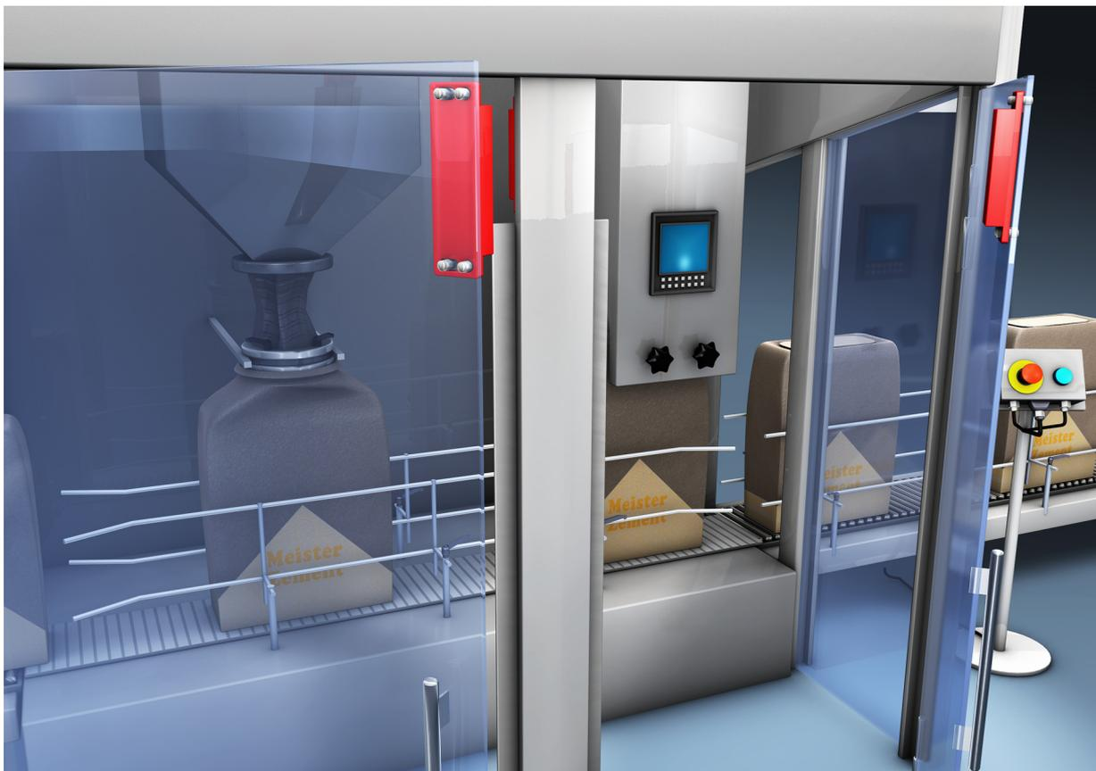
Fig. 5.2: Protección de accesos en una instalación de llenado, realizada en una puerta con sensores MC388x
