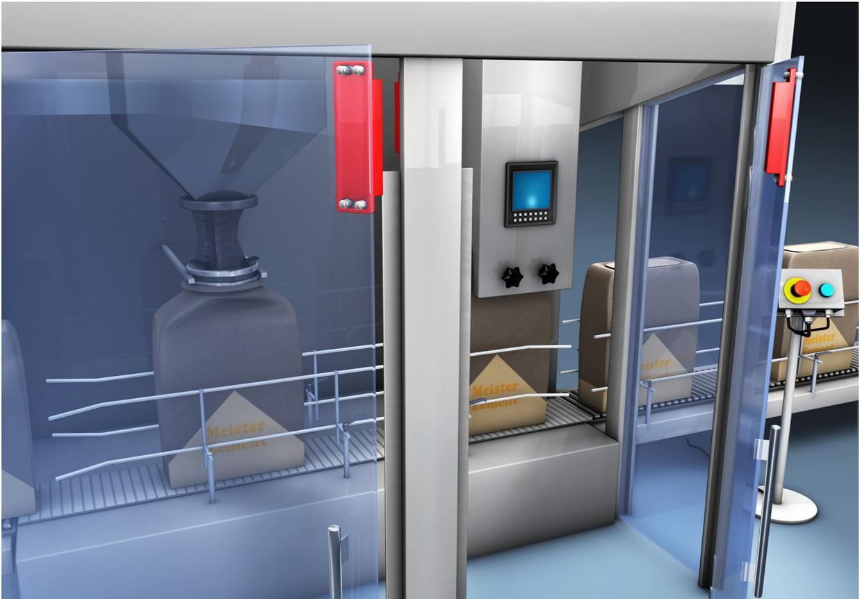
Bild 5.2: Zugangssicherung an einer Abfüllanlage, realisiert an einer Tür mit MC388x Sensoren
