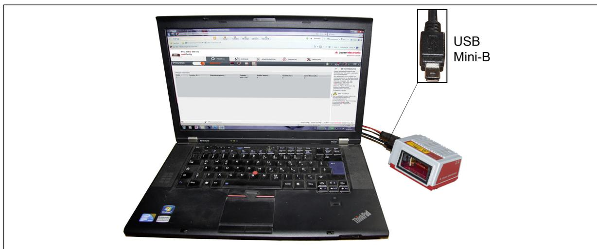
Figura 9.1: Collegamento dell'interfaccia USB DI ASSISTENZA
