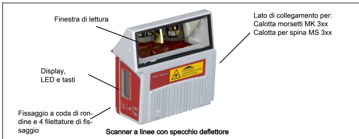
Figura 4.4: Struttura del dispositivo BCL 358*i* - Scanner a linee con specchio deflettore
