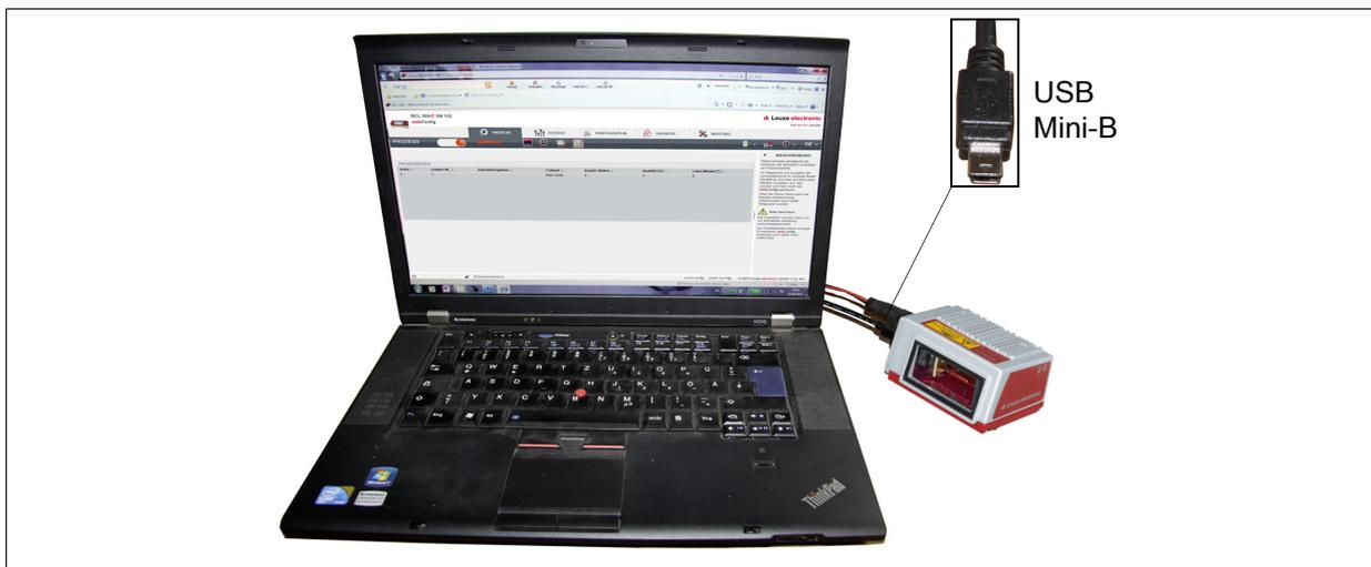
Bild 9.1: Anschluss der SERVICE USB-Schnittstelle
