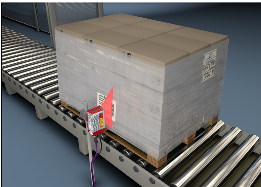
Figure 4.9 : Principe de déviation du scanner monotrame
