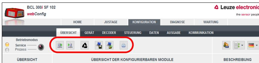
Bild 10.1: Speicherung von Konfigurationsdaten im webConfig Tool
