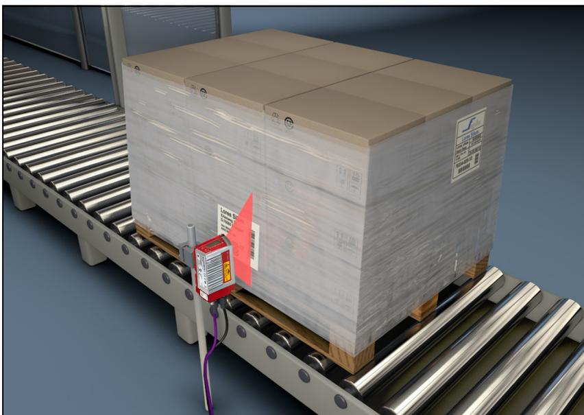
Bild 4.9: Ablenkprinzip für den Linienscanner
