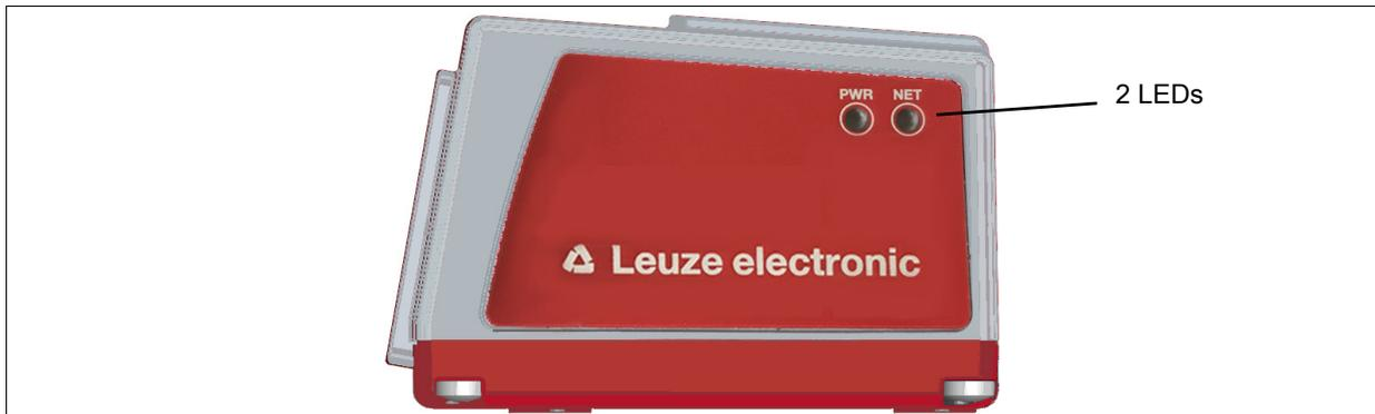
Bild 8.1: BCL 304/i - LED Anzeigen
