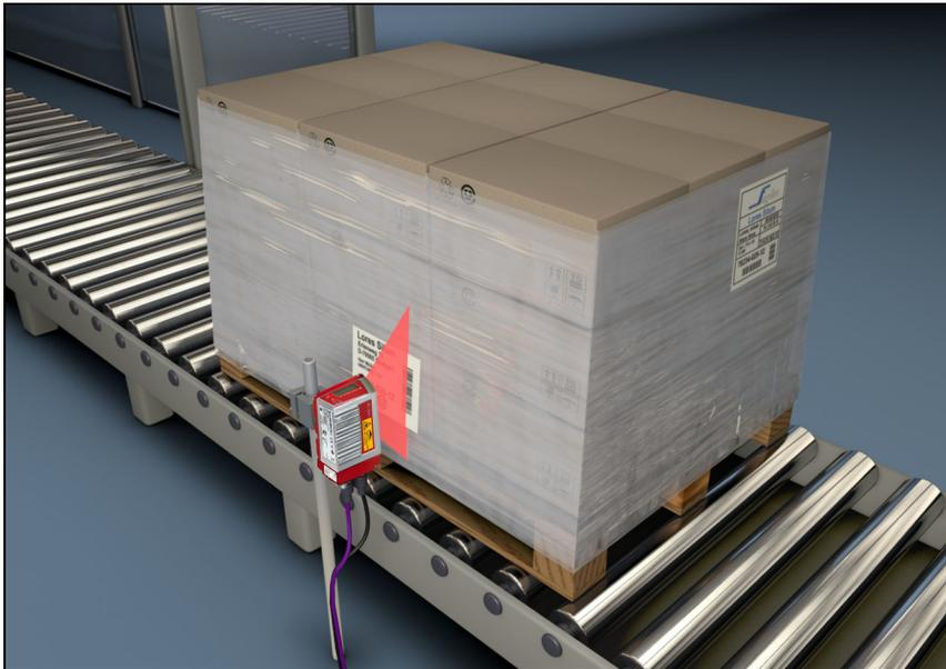
Figure 4.10 : Principe de déviation du scanner monotrame
