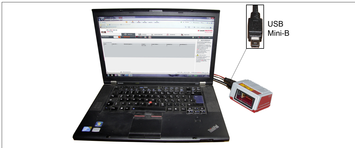
Fig. 9.1: Conexión de la interfaz de servicio USB
