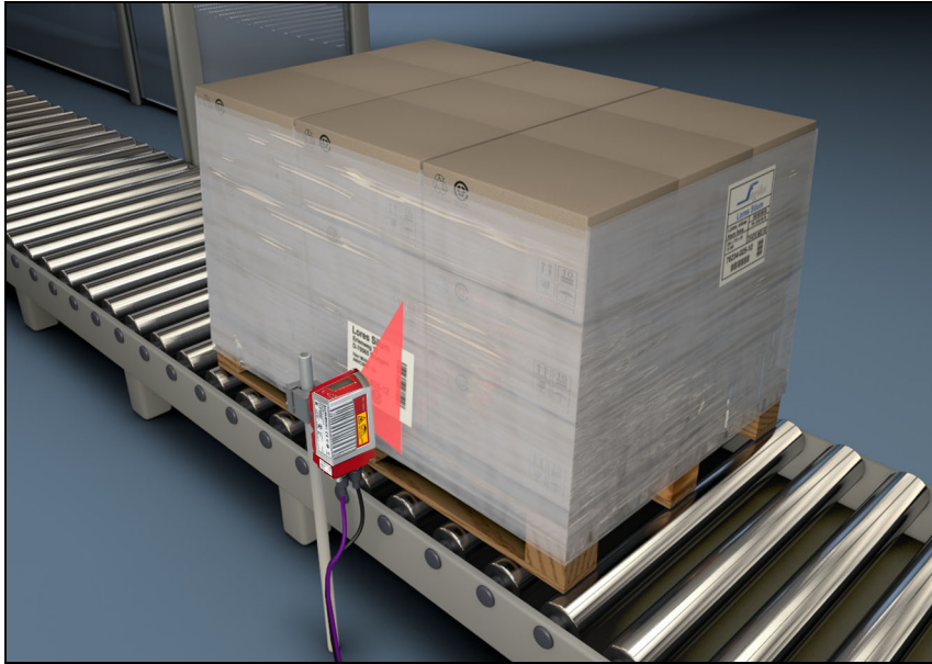
Fig. 4.10: Principio de barrido del escáner lineal
