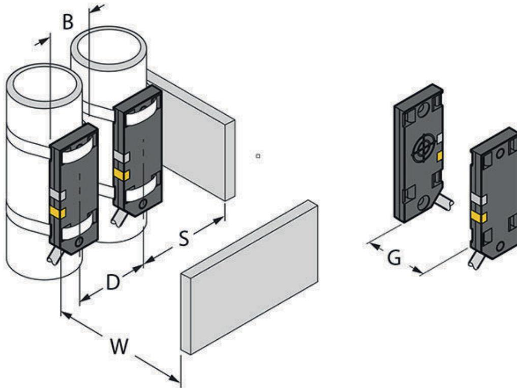
B Ø 20 mm, diamètre de la surface active
