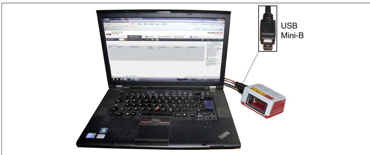
Figura 9.1: Collegamento dell'interfaccia USB DI ASSISTENZA
