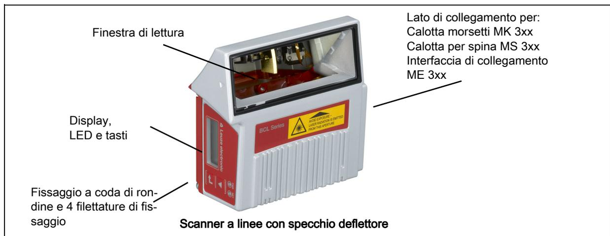
Figura 4.4: Struttura dell'apparecchio BCL 338*i* - Scanner a linee con specchio deflettore
