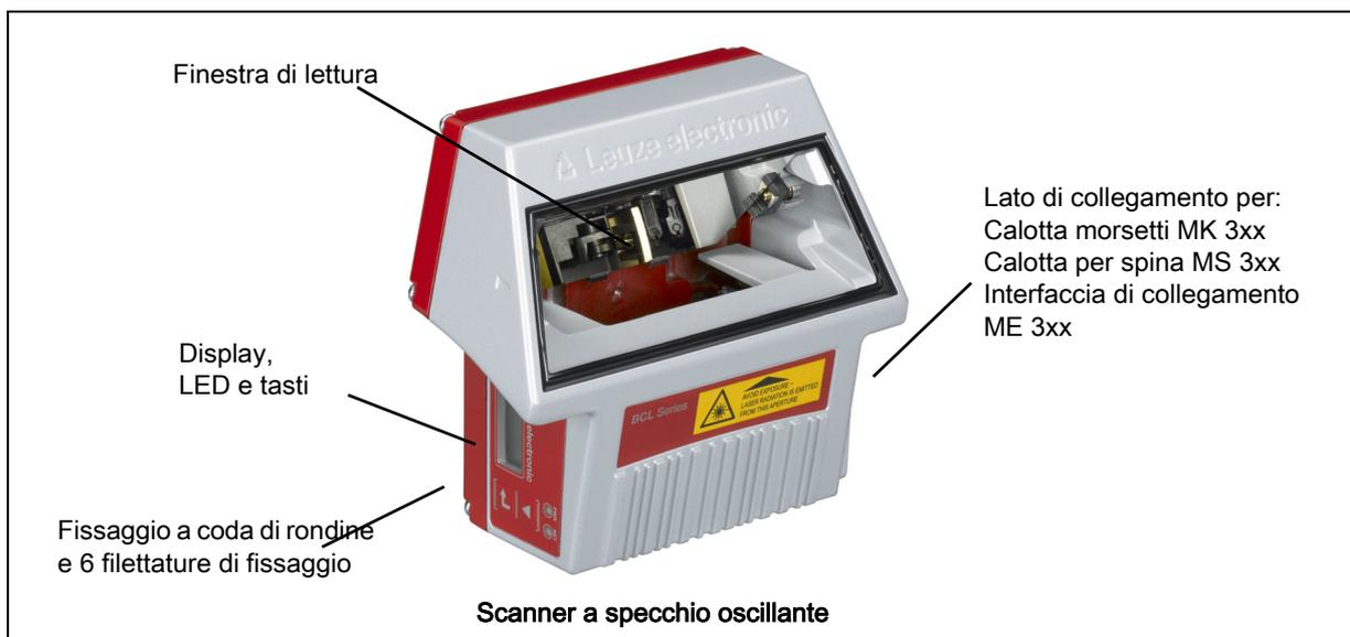
Figura 4.5: Struttura dell'apparecchio BCL 338/i - Scanner a specchio oscillante
