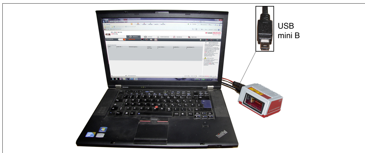
Figure 9.1 : Raccordement au port USB de MAINTENANCE
