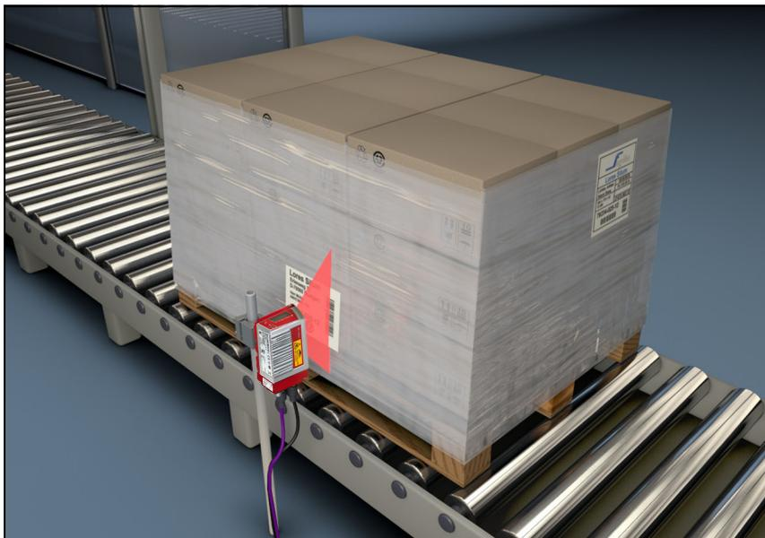
Fig. 4.9: Principio de barrido del escáner lineal
