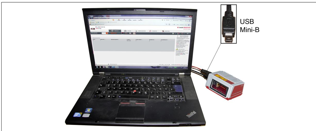
Fig. 9.1: Conexión de la interfaz de servicio USB
