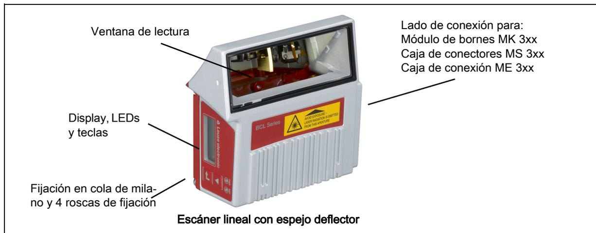
Fig. 4.4: Estructura del equipo BCL 348*i*- Escáner lineal con espejo deflector
