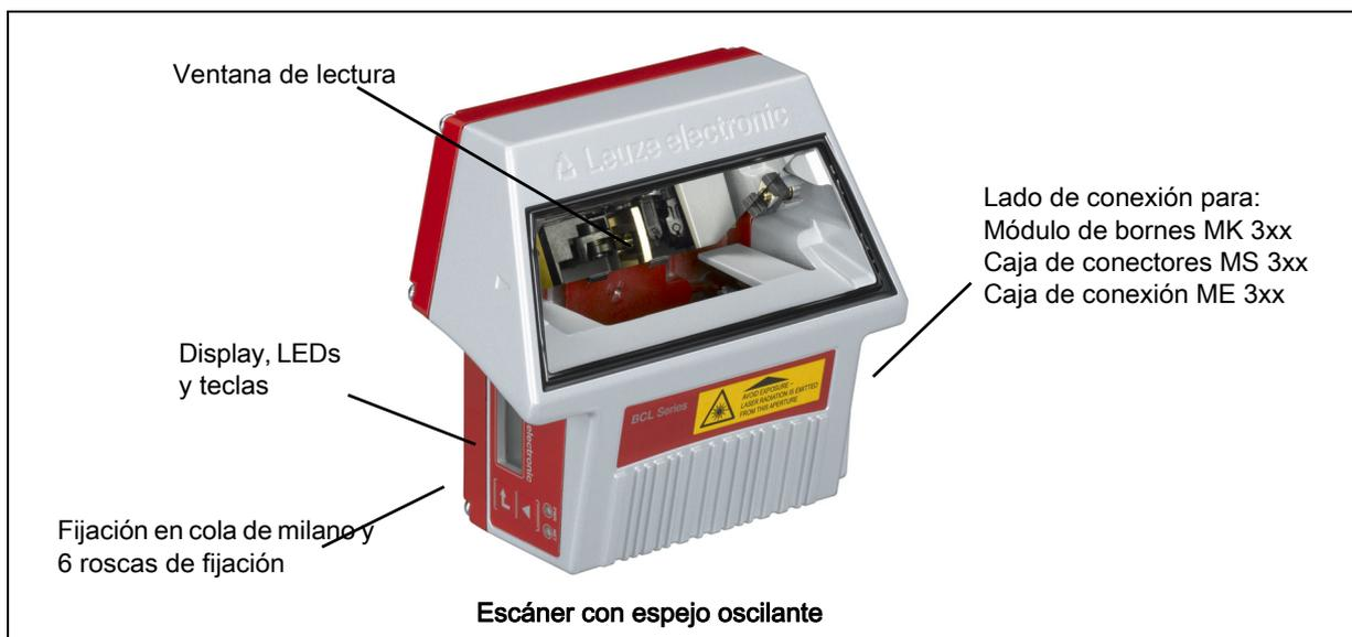
Fig. 4.5: Estructura del equipo BCL 348/i - Escáner con espejo oscilante
