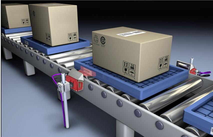
Fig. 4.11: Principio de deflexión del escáner multihaz (raster)
