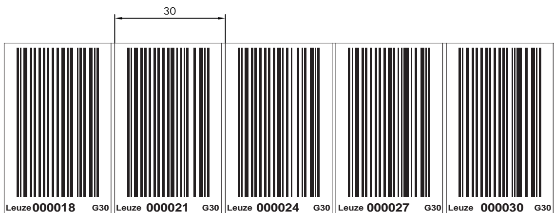
Figura 11.2: Verifica del risultato di stampa del kit di riparazione BCB G30 ... (reticolo da 30 mm)
