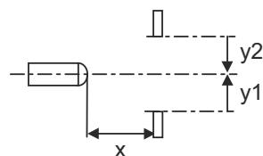
Réaction typ. (distance de réglage 1200 mm)
