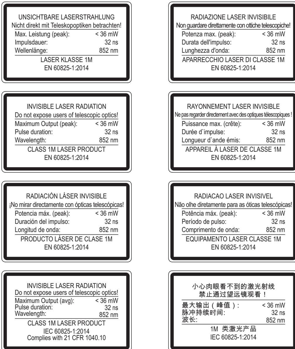
Bild 2.3: Laserhinweisschilder für Geräte mit Frequenz F4
