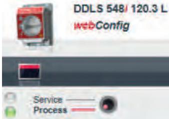
Bild 9.4: Umschaltung des Betriebsmodus (Prozess - Service)
