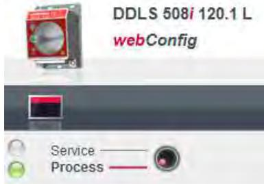
Bild 8.4: Umschaltung des Betriebsmodus (Prozess - Service)
