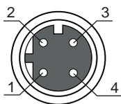
Bild 5.3: Anschlussbelegung BUS-Anschluss
