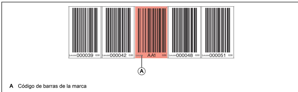
Fig. 5.5: Disposición del código de barras de la marca en el sistema
