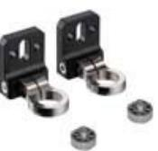
6    | 429029         | BT-2RG                      | Kit de support                        | Contenu: 2 supports tournants BT-R, 2 cylindres pour la fixation à la barrière immatérielle<br>Fixation, côté installation: Fixation traversante<br>Fixation, côté appareil: Serrable<br>Type de pièce de fixation: Pivotant 360°<br>Matériau: Métallique, Plastique                                                                            |
