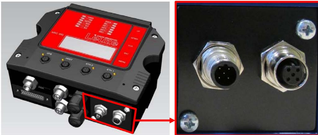
Abbildung 9 – PROFIBUS-Steckverbinder
