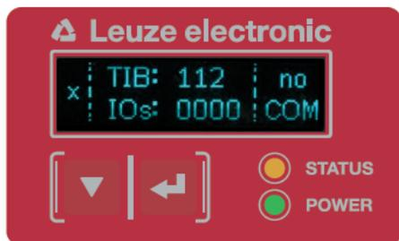
Bild 8.3: Displaydarstellung des Prozessbetriebszustands des Lichtvorhangs
