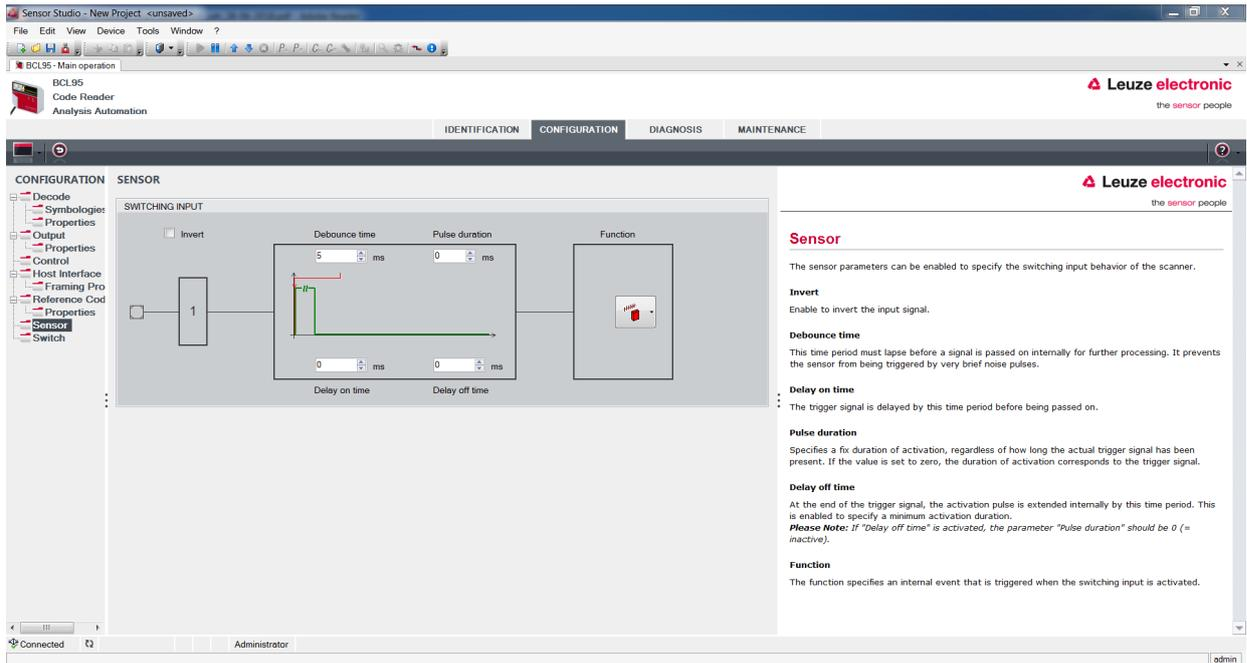
图 6.12: 控制输入端寄存器 (Switching Input)
