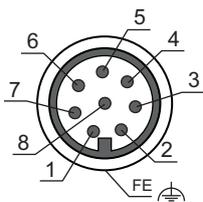
图 5.1: 引线布局 M12 插口 · 8 针 · A 编码
