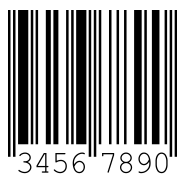
Fig. 15.7: Type de code 07 : EAN 8
