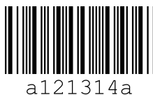
Fig. 15.2: Type de code 02 : Code 39
